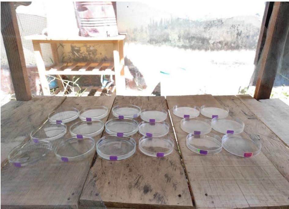
Figura 28. Instalacion de placas receptoras P1
