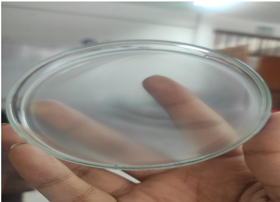
Figura 36. Placa de vidrio cubierta con vaselina
