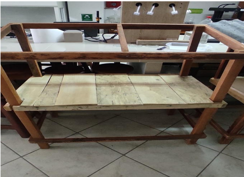
Figura 42. Construcción de soporte de placas receptoras
