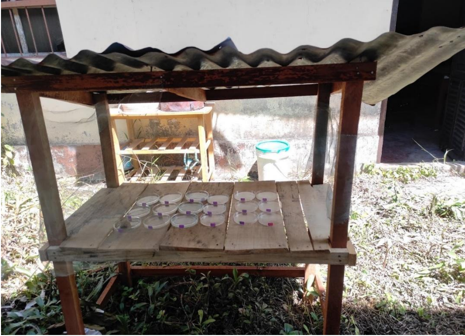
Figura 27. Instalacion de placas receptoras P1
