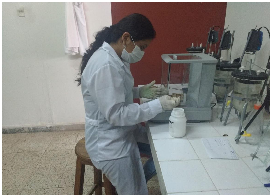
Figura 13. Pesaje del \text{Pb}(\text{NO}_3)_2 .
