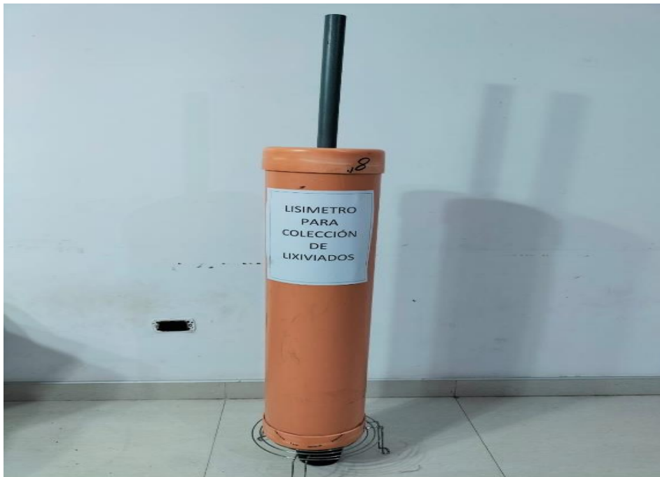
Figura 9. Estructura del lisímetro utilizado en la investigación.
