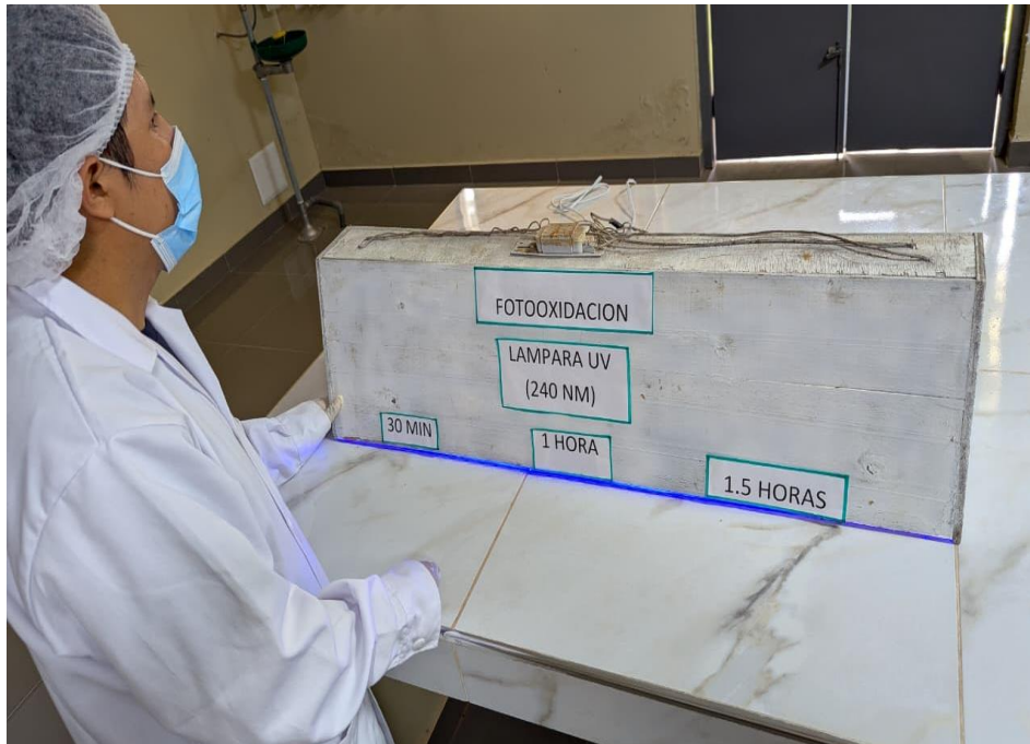
Figura 27. Sistema experimental para la aplicación de la fotooxidación del Lixiviado con radiación UV.
