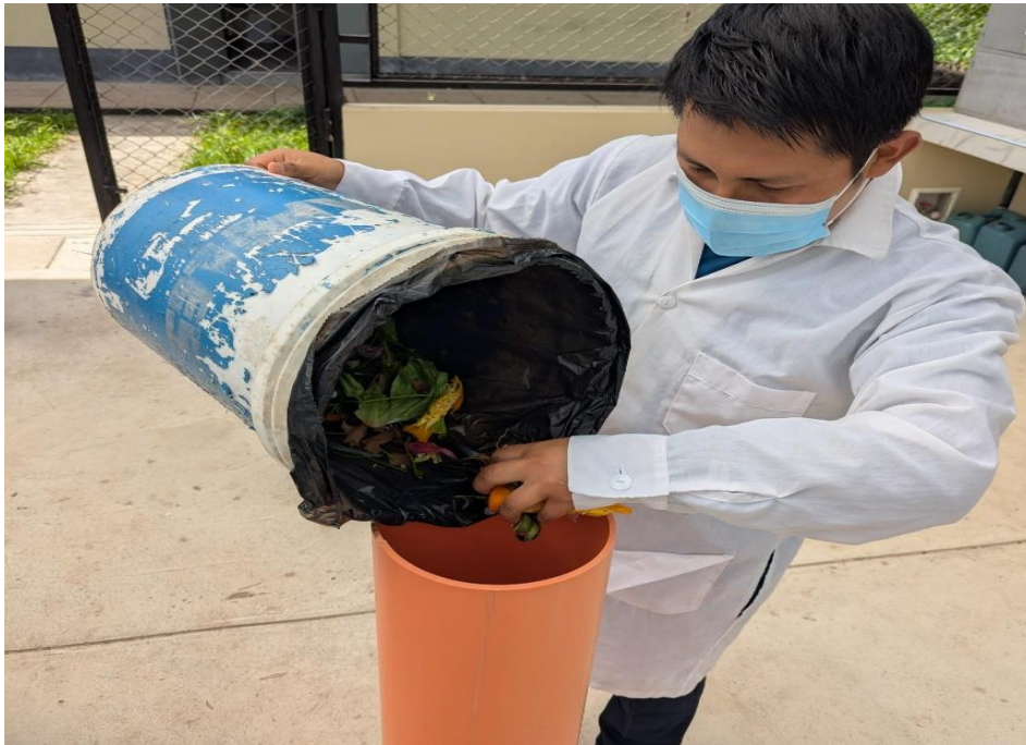
Figura 15. Carga del lisímetro con residuos sólidos orgánicos.
