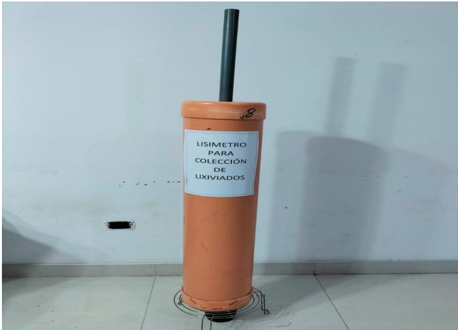
Figura 14. Lisímetro utilizado para la generación de lixiviados.
