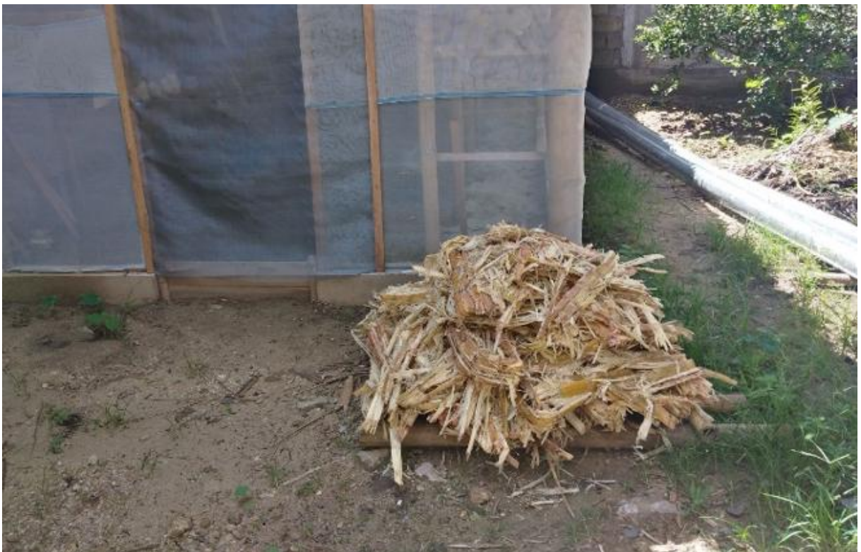
Figura 22. Bagazo de caña de azúcar secando al sol luego de su lavado, para después ser picado en secciones de 2 a 3 cm.
