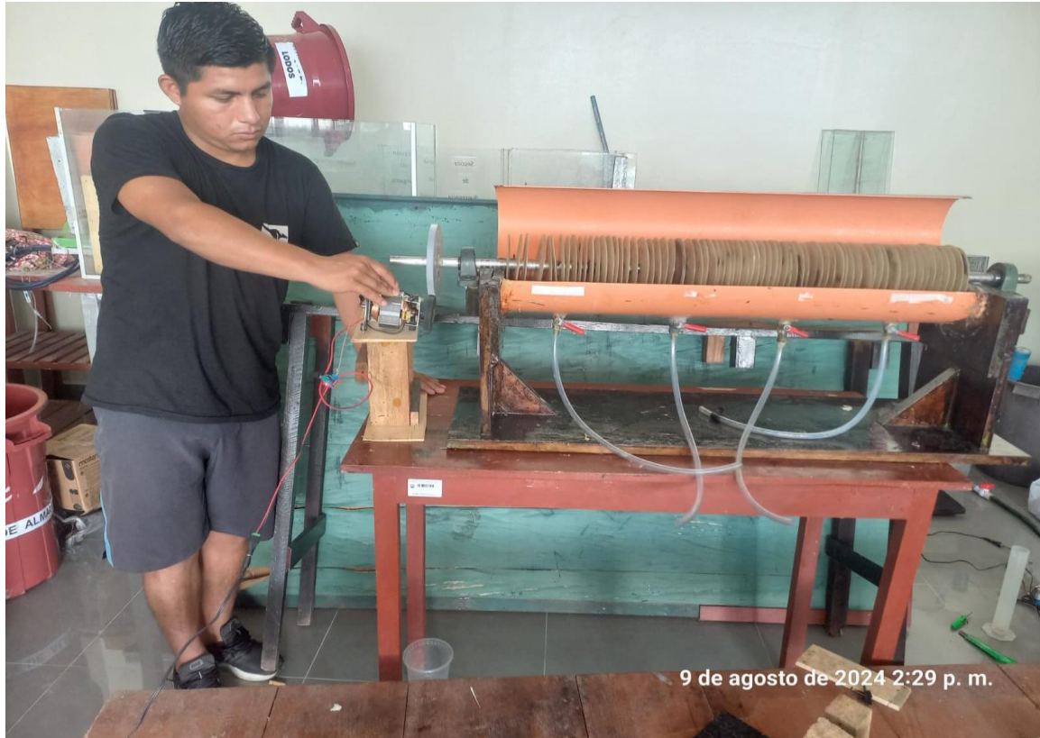
Figura 13. Construcción del sistema de Biodiscos
