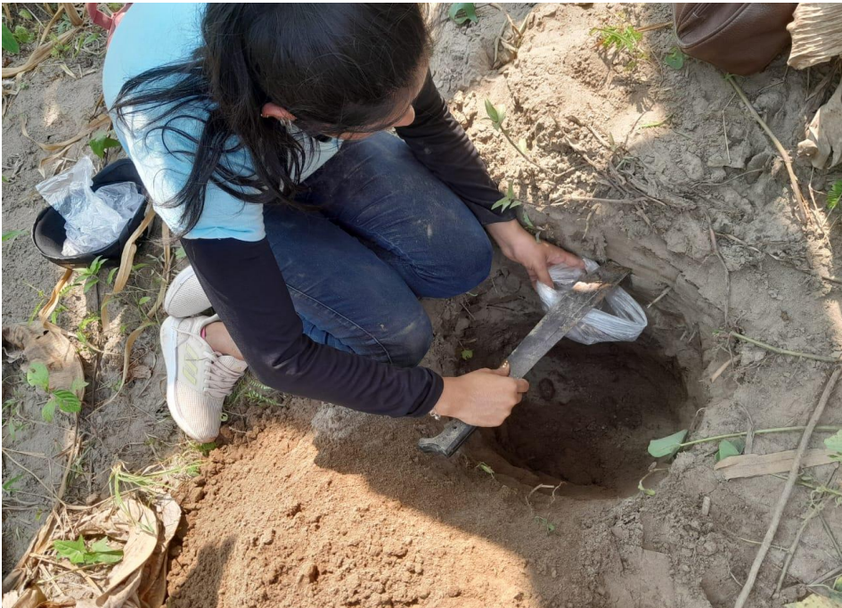
Figura 20. Obtención de muestras de suelo por horizontes
