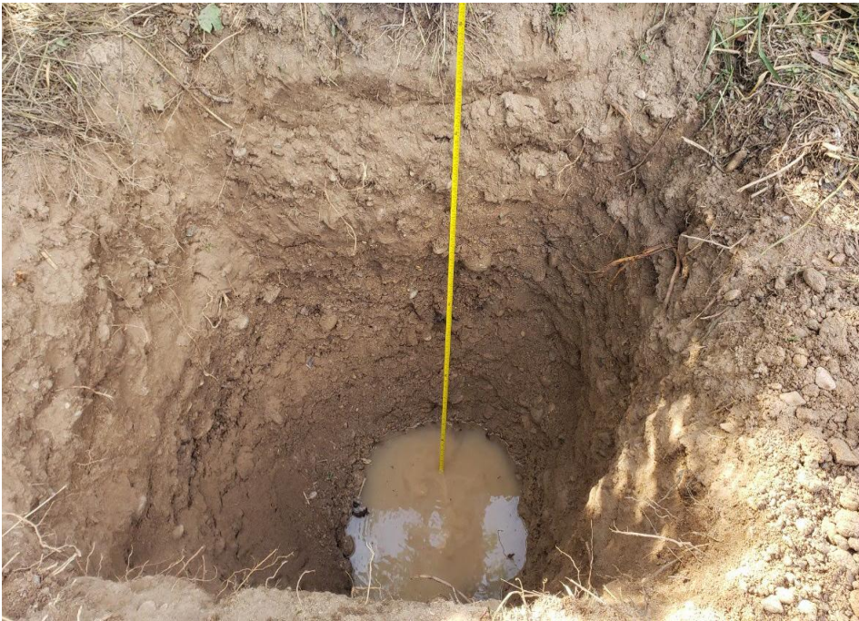
Figura 18. Napa freática de la calicata N° 5 (1.30m)
