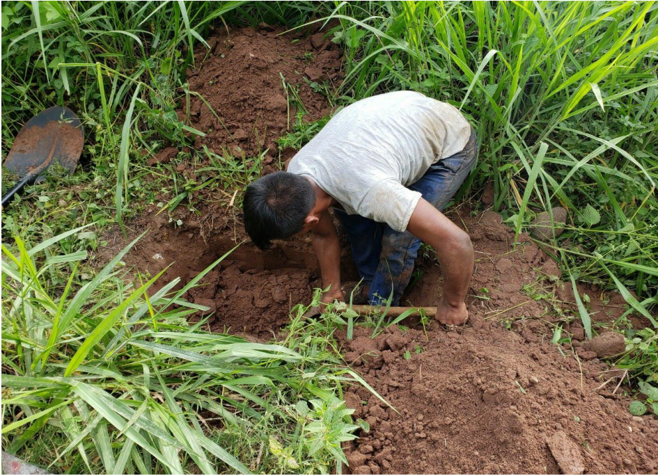
Figura 17. Realizando las calicatas en la Isla Soto
