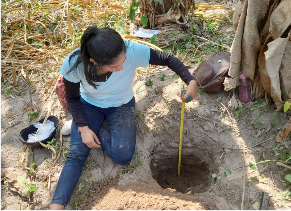
Figura 19. Realizando la medición de la calicata N° 2
