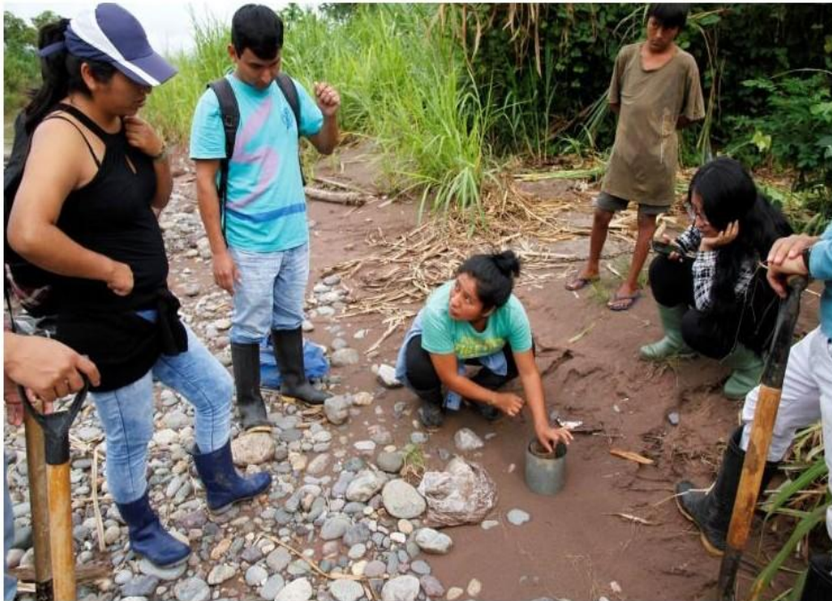
Figura 16. Realizando ensayo de infiltración
