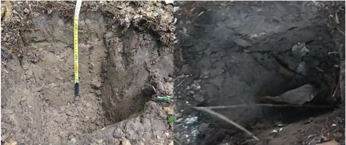
Figura 20. Evaluación del color del suelo desde 0 cm a 30 cm de profundidad
