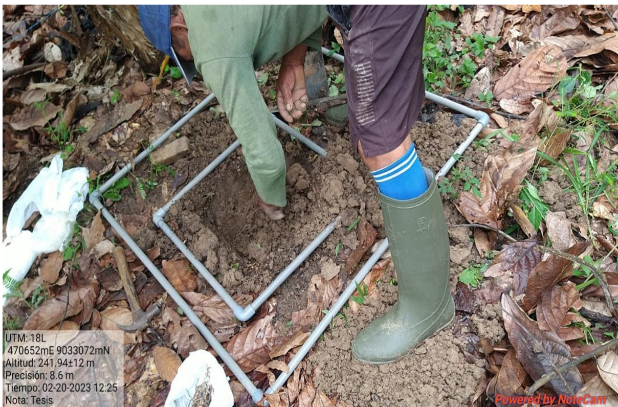
Figura 19. Evaluación de la densidad aparente del suelo
