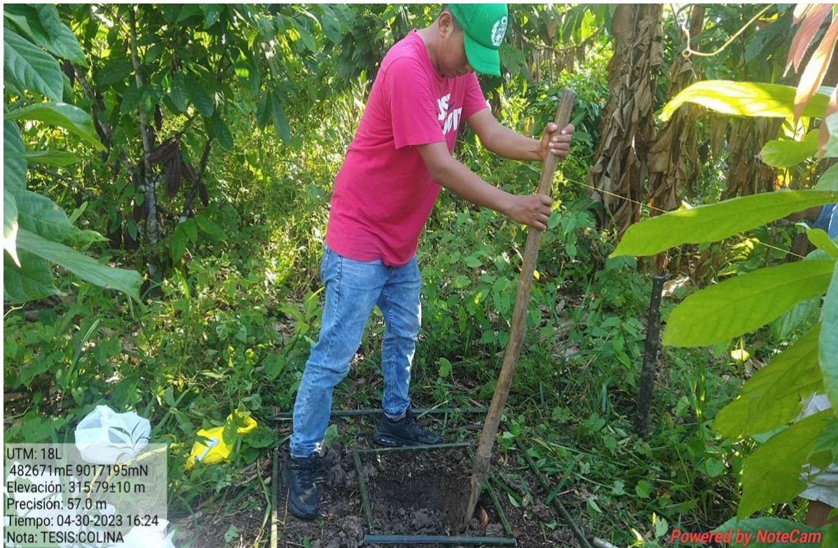
Figura 18. Apertura de calicata en los transectos para el muestreo de suelo
