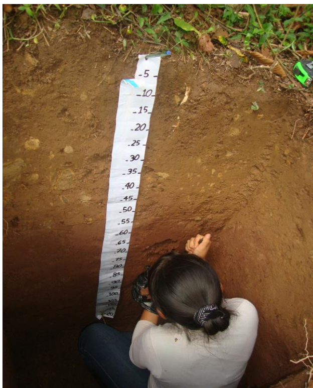
Figura 16. Tomando muestras de la calicata.
