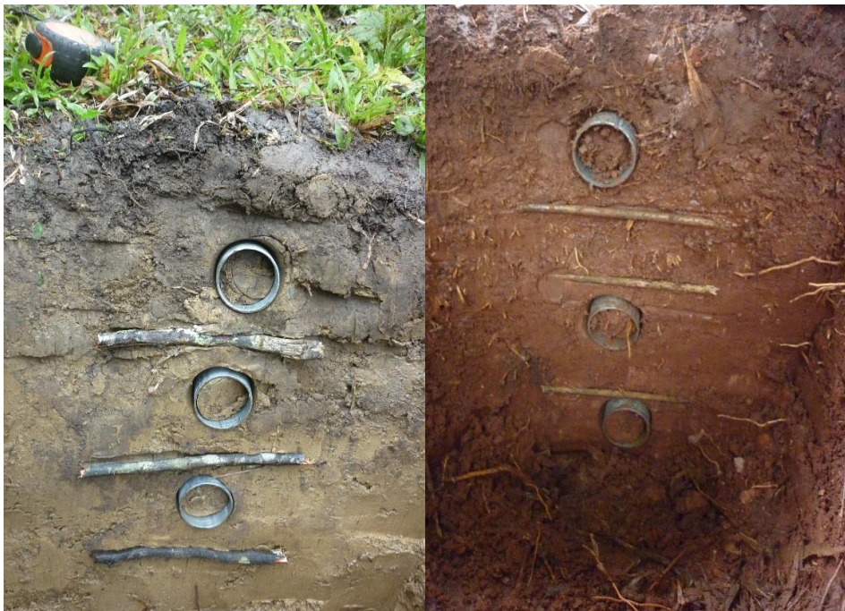
Figura 41. Cilindros muestreadores a profundidad de 0-10, 10-20 y 20-30 cm.
