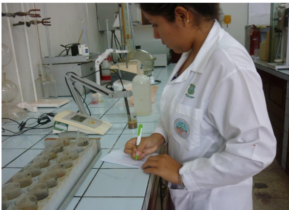
Figura 45. Realizando la lectura con el potenciómetro para el análisis de pH.
