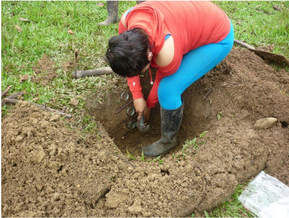
Figura 40. Ejecución de las calicatas de 30x30x50 cm.
