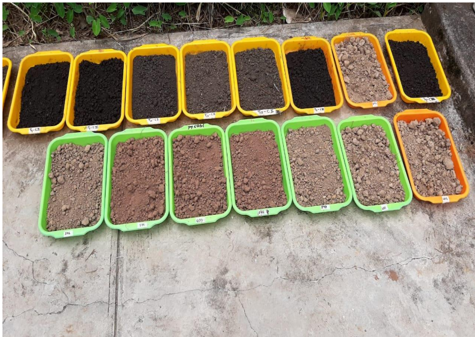
Figura 1612. Proceso de secado de las muestras de suelos del CP Ramal de Cachiyacu.
