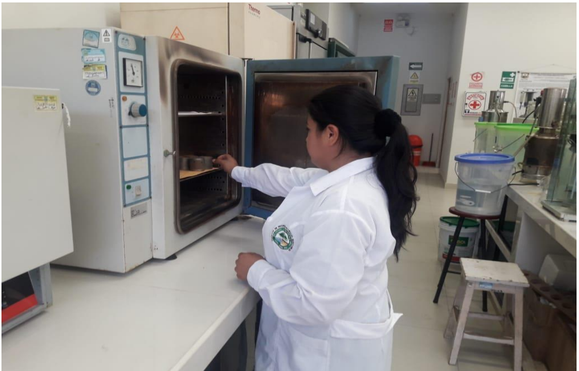
Figura 15. Secado de muestras de suelo en mufla para hallar la densidad aparente
