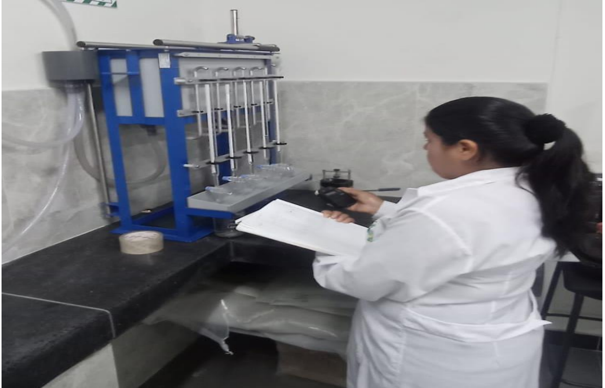
Figura 16. Medición de la conductividad hidráulica del suelo
