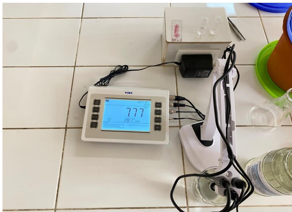
Figura 23. El multiparámetro como herramienta principal para la determinación de la calidad del agua.
