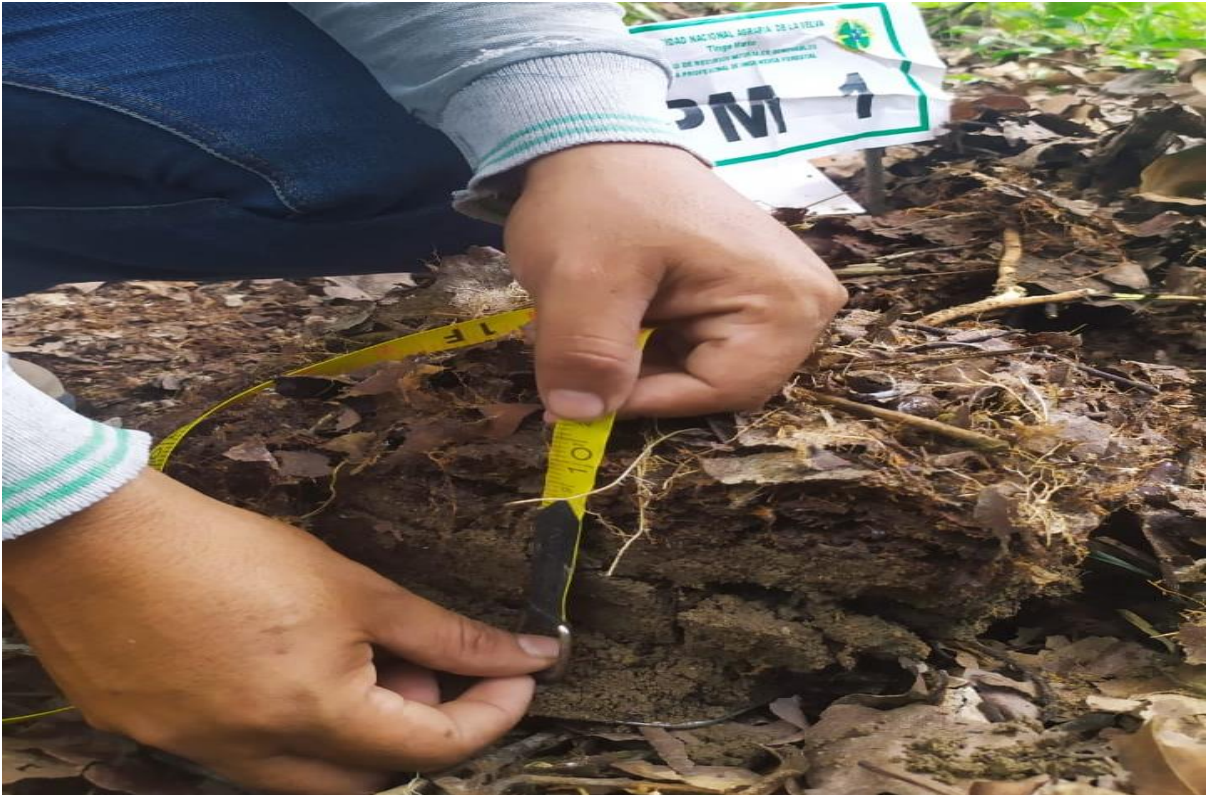
Figura 24 Medición de la muestra desde la superficie hasta los 10 cm de profundidad.
