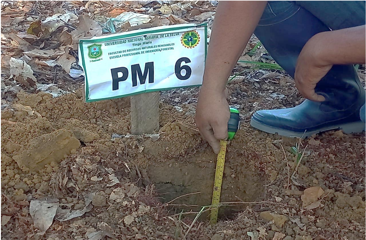
Figura 22. Medición a dos profundidades los puntos de muestreo.
