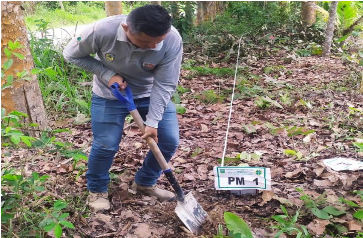
Figura 23. Apertura de hoyos para el muestreo de suelos con palana.
