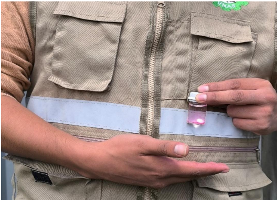
Figura 30. Coloración de la celda por reacción del reactivo con el cloro.
