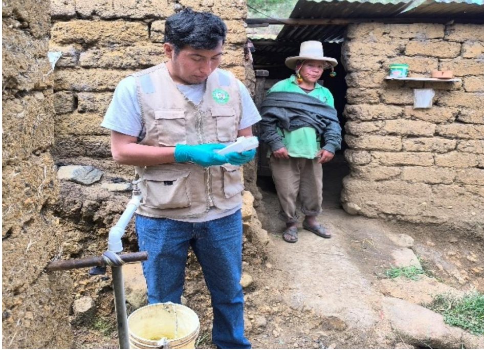
Figura 33. Medición de cloro residual de la vivienda 71
