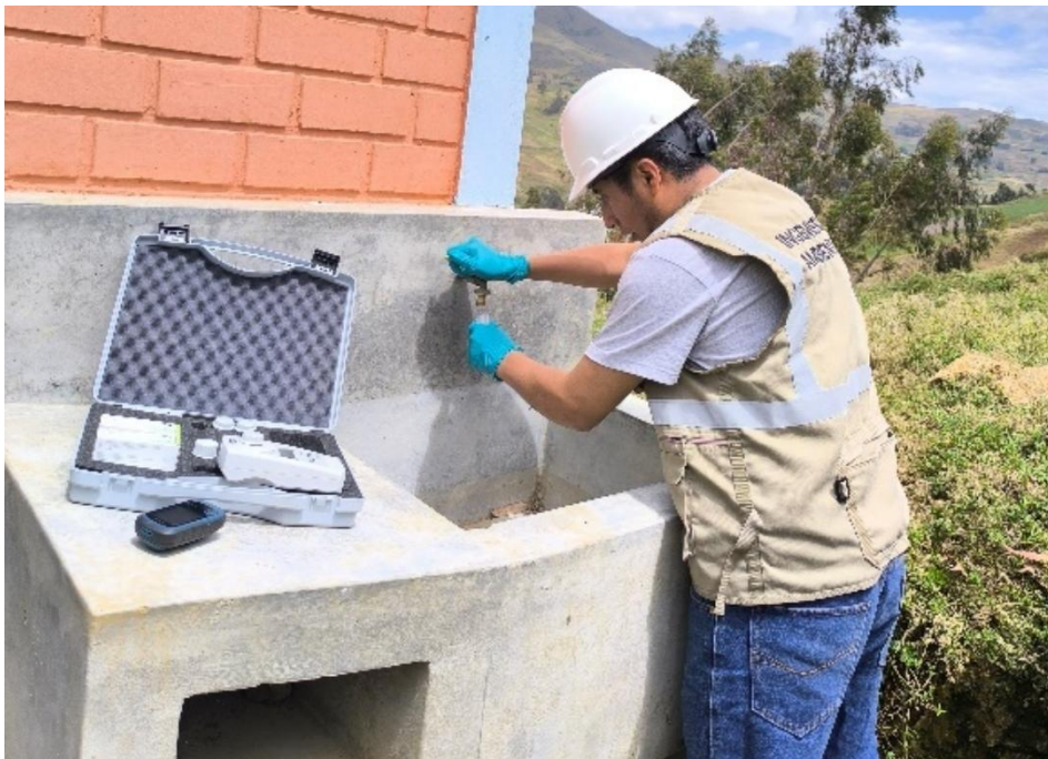
Figura 32. Toma de muestra de la vivienda 53 para cloro residual.
