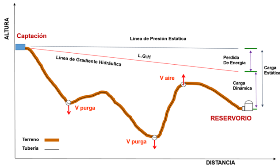
Figura 3. Línea de conducción.
