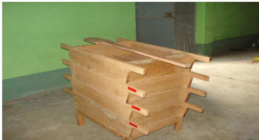
Ilustración 37: Fermentador F3 prototipo clásico de gaveta de madera tipo ROHAN.
