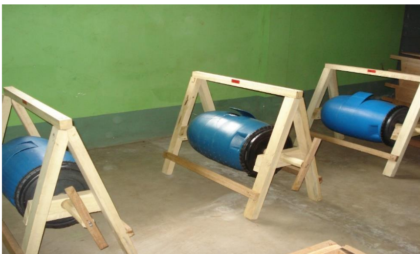
Ilustración 36: Fermentador F2 prototipo cilíndrico de plástico de grado alimentario.
