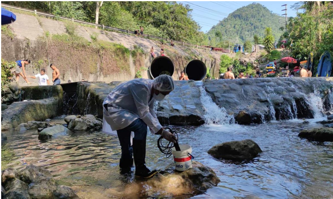
Figura 18. Medición de parámetros fisicoquímicos en el punto 2 de la Alcantarilla
