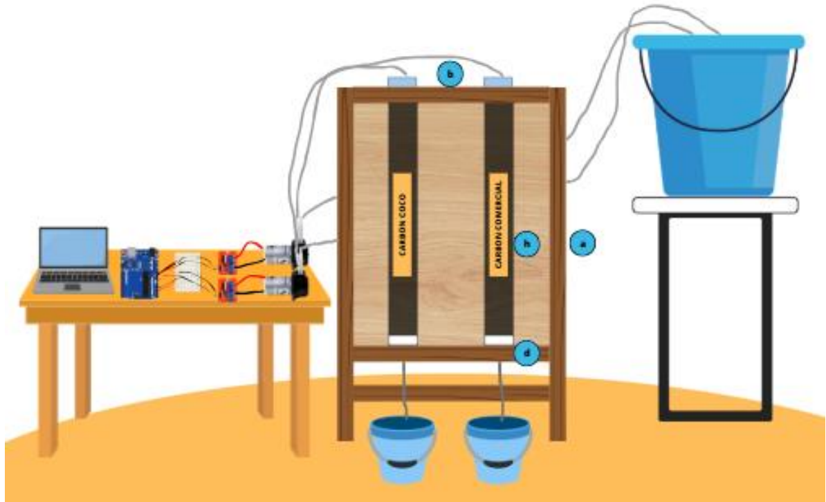
Figura 7. Esquema del sistema del sistema de adsorción por carbón activado en lecho fijo
