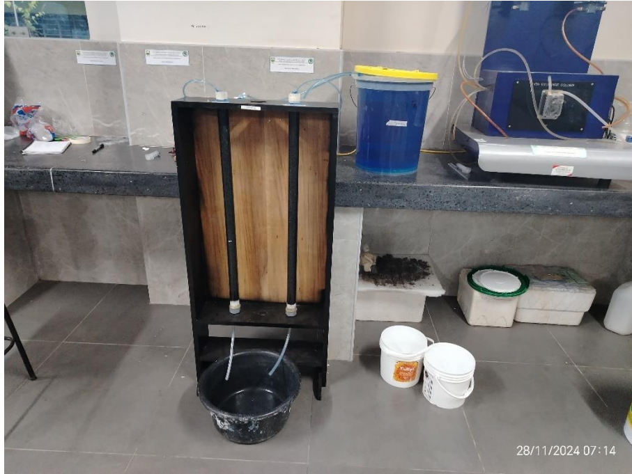
Figura 20. Sistema de adsorción por carbón activado en lecho fijo
