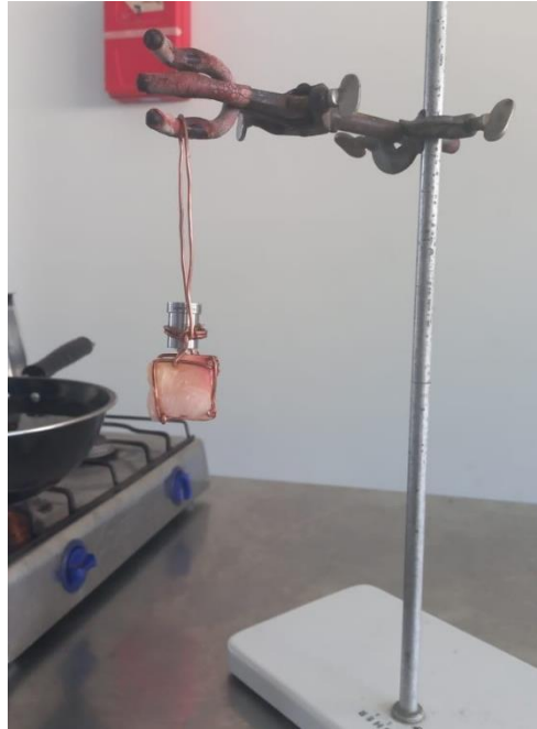
Figura 1: Acondicionamiento de la carne de pescado en una rejilla de cobre.
