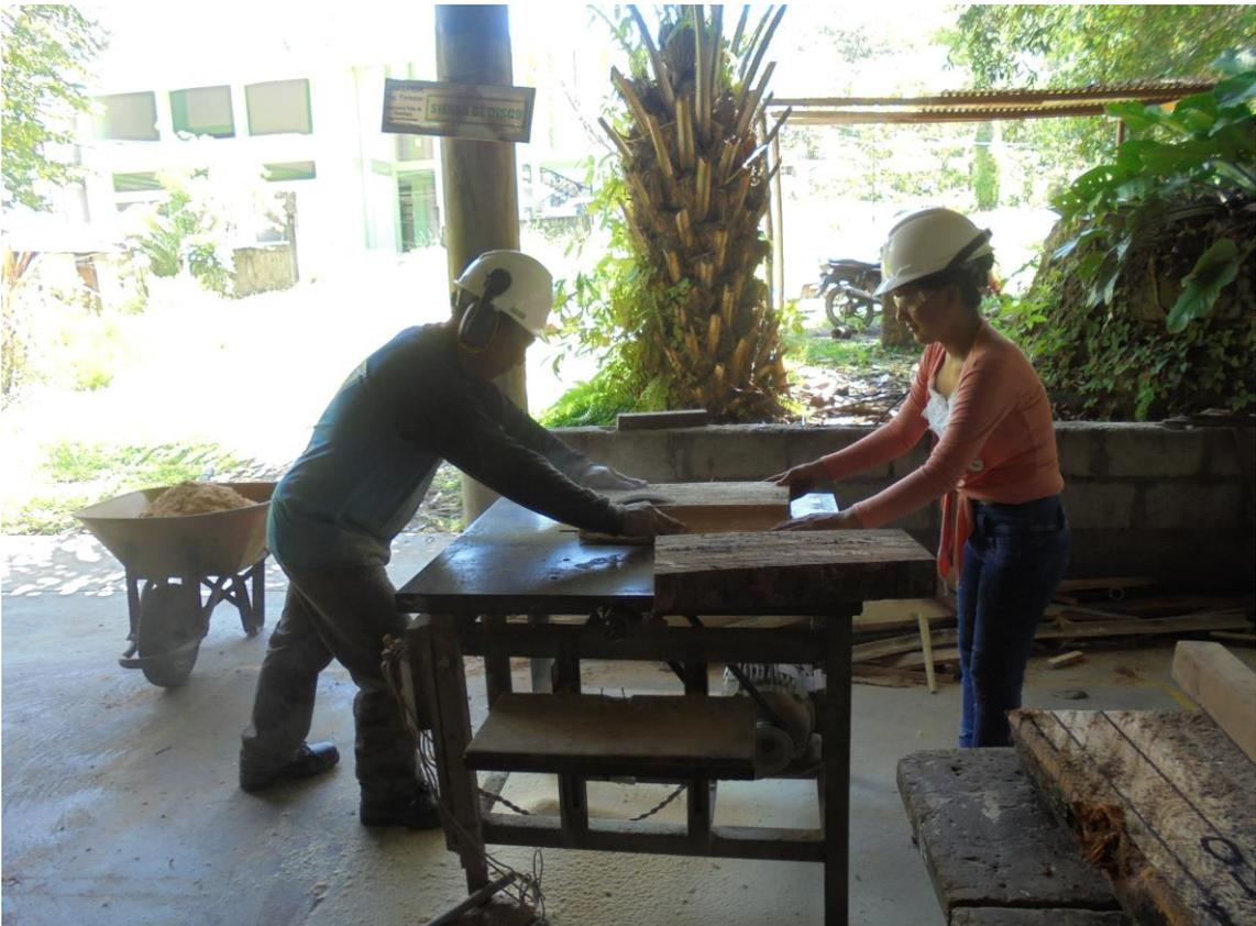
Figura 46. Habilitado de los tablonces para obtener probetas.
