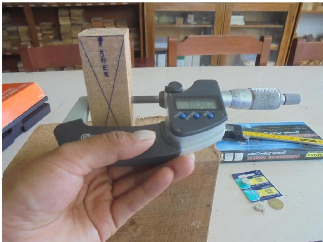
Figura 51. Medición de las probetas.
