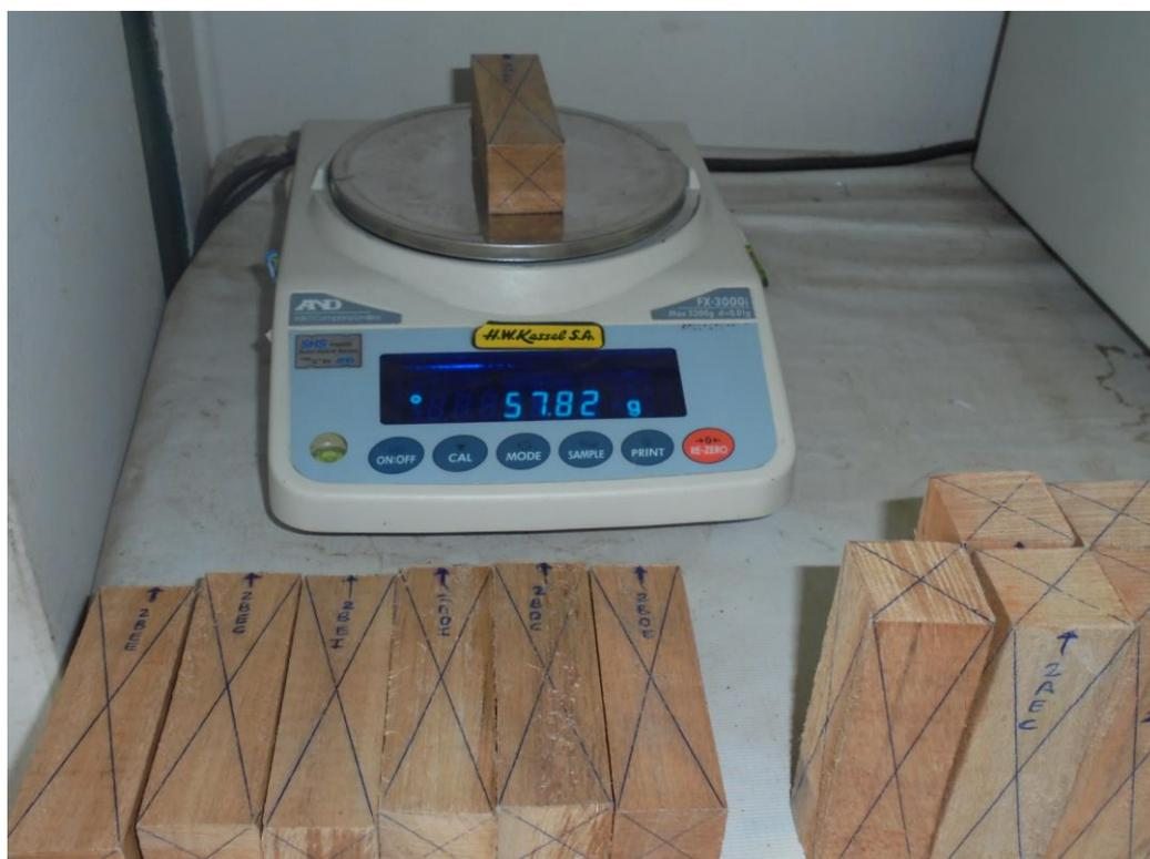
Figura 50. Pesado de las probetas.
