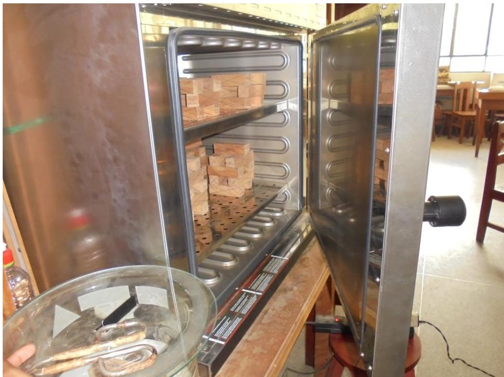
Figura 48. Secado de las probetas en estufa.
