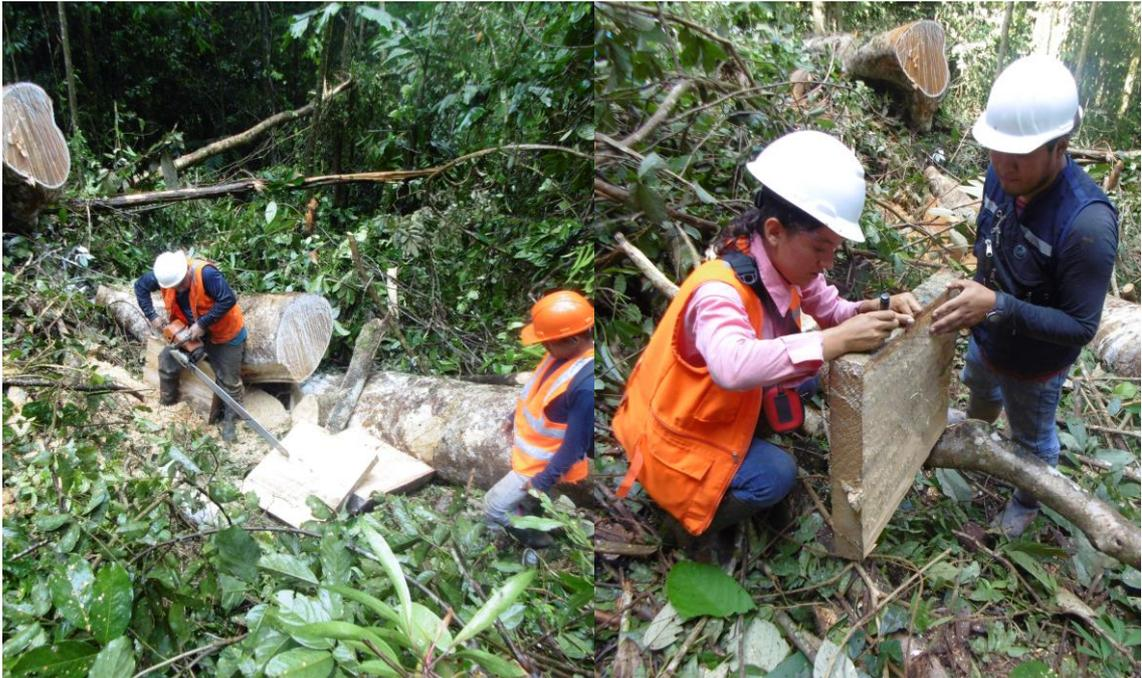
Figura 45. Codificación de muestras de madera.
