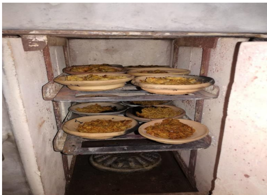
Figura 34. Cocción de las muestras semisecas a 350°C para la eliminación de impurezas
