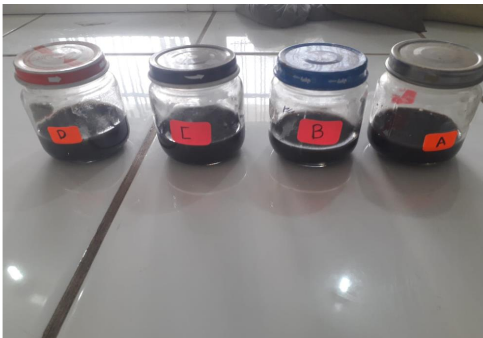
Figura 35. Dilución de las muestras en ácido clorhídrico HCl al 68%, listas para su medición y análisis en el equipo de espectrometría de absorción atómica
