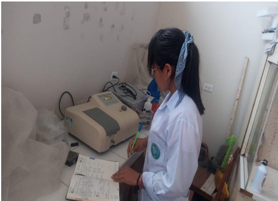
Figura 40. Determinación de la absorbancia de la muestra centrifugada
