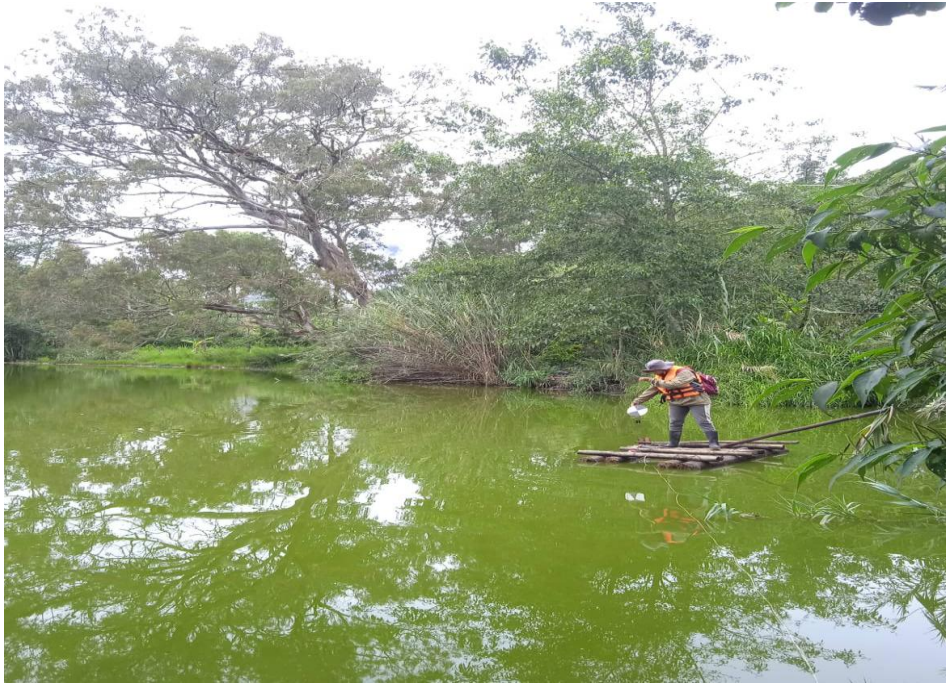
Figura 27. Medida de la transparencia del agua con el Disco de Secchi
