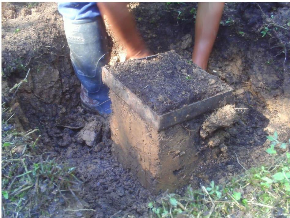
Figura 2. Realizando la extracción del monolito del suelo
