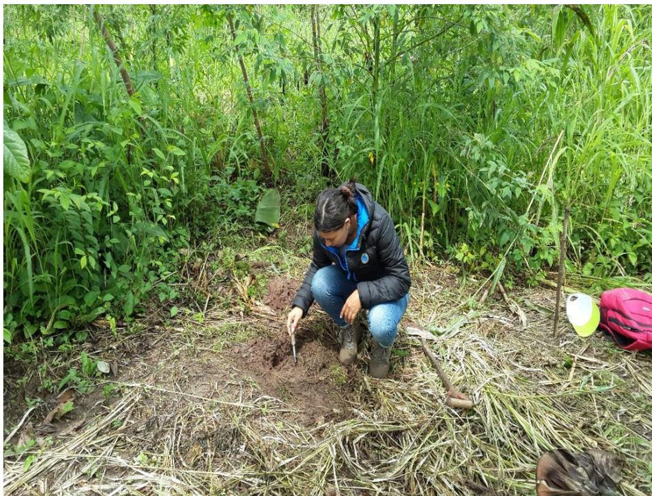
Figura 1. Evaluando la resistencia del suelo con el penetrómetro
