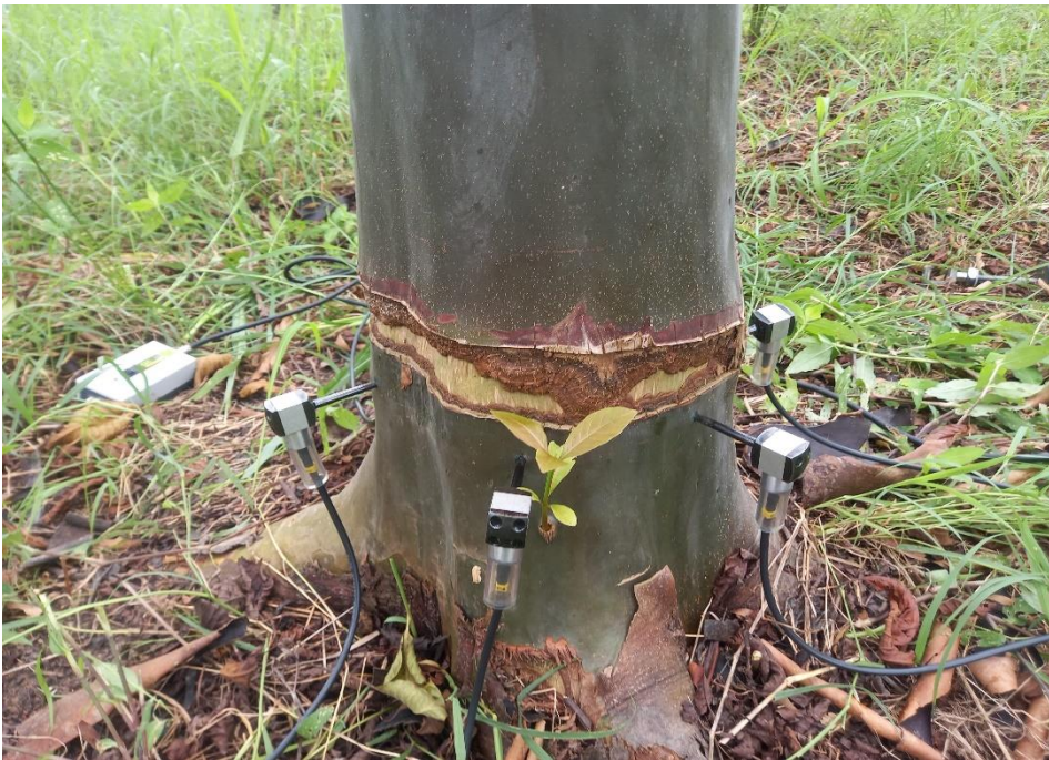
Figura 58. Sensores colocados en el árbol de C. spruceanum .
