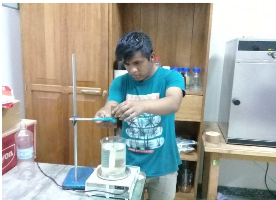
Figura 30. Calculo del volumen por principio de Arquimides
