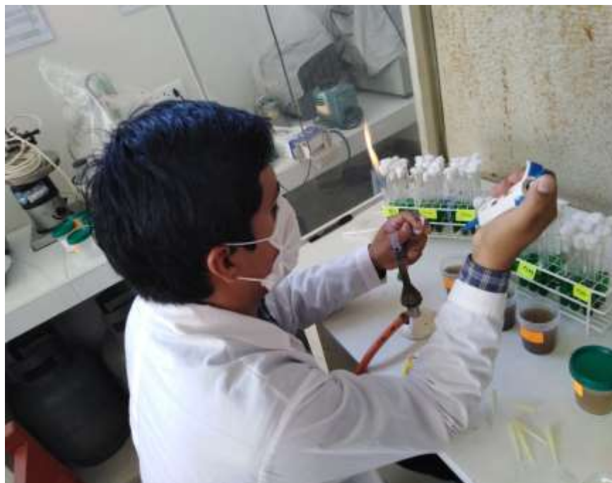
Figura 38. Inoculación de la muestra para la determinación de coliformes totales.
