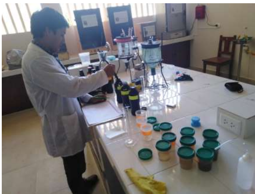
Figura 40. Lectura OD para la Demanda bioquímica de oxígeno por cinco días.
