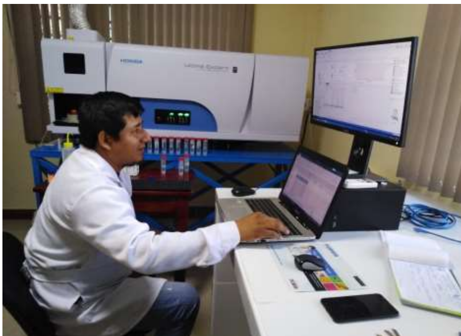
Figura 46. Lectura de las muestras con el equipo ICP-OES
