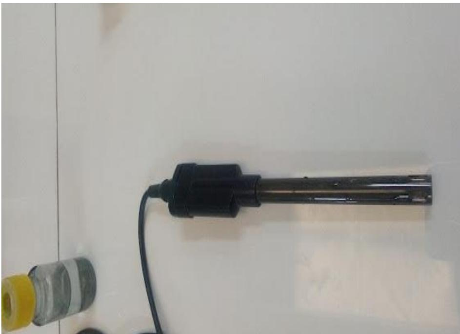
**Figura 58.** Electrodo marca HACH para medición de pH
