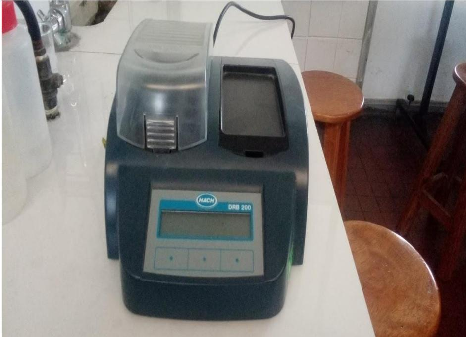
**Figura 61.** Digestor DQO marca HACH utilizado en la investigación
