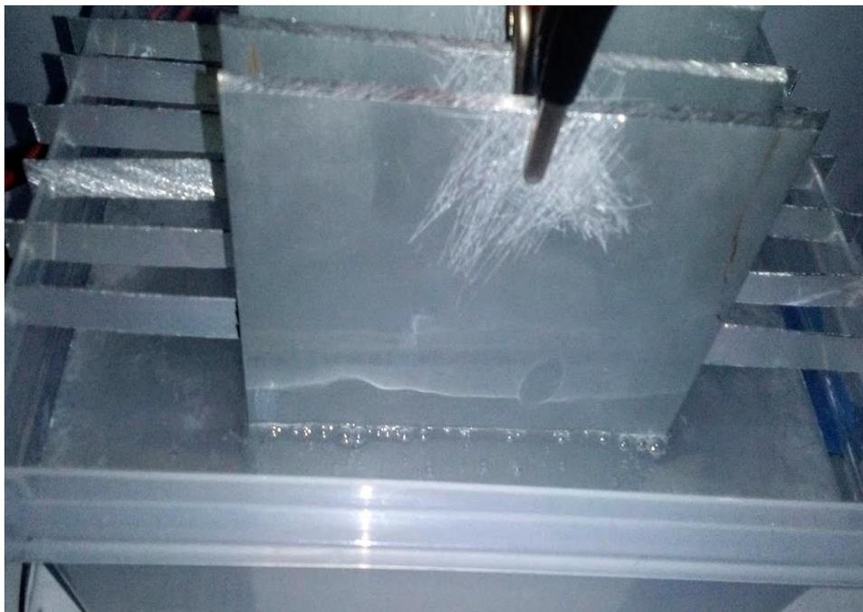
**Figura 42.** Prueba de funcionamiento de la celda de electrocoagulación
