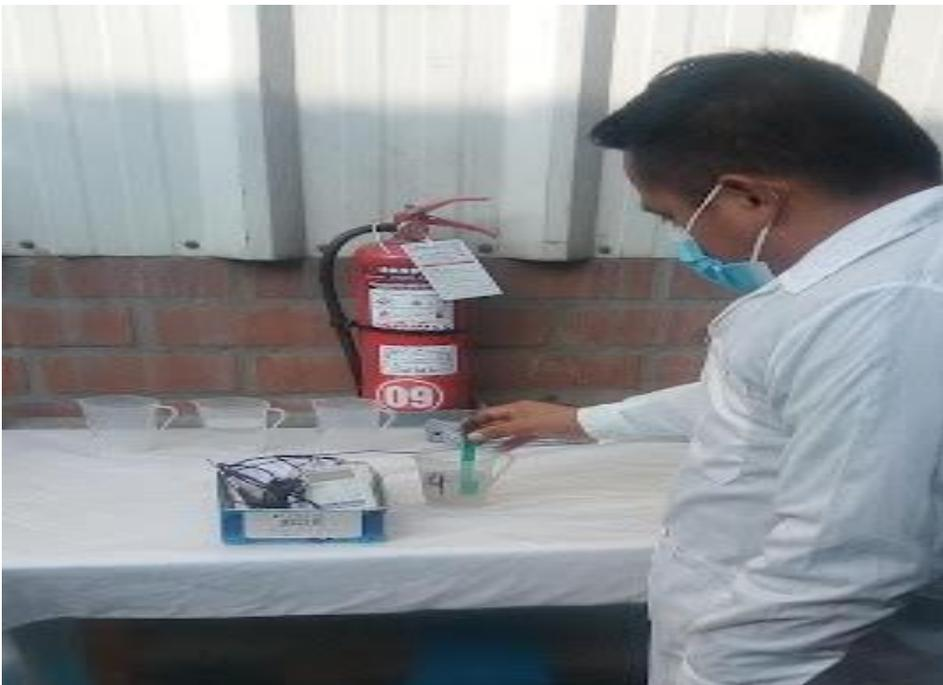
**Figura 38.** Medición de pH in situ
