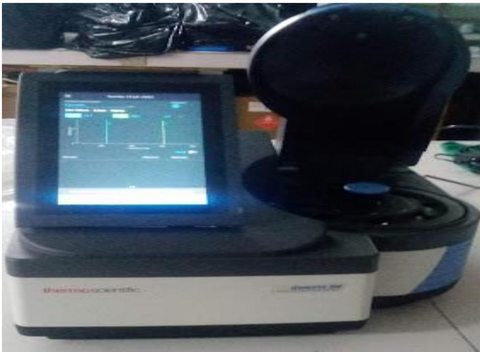
**Figura 56.** Medición de DQO en espectrofotometro
