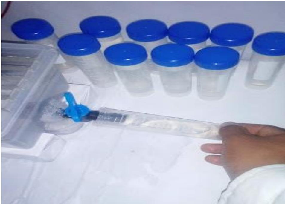
**Figura 50.** Toma de muestra de disolución al 75% v/v del efluente
