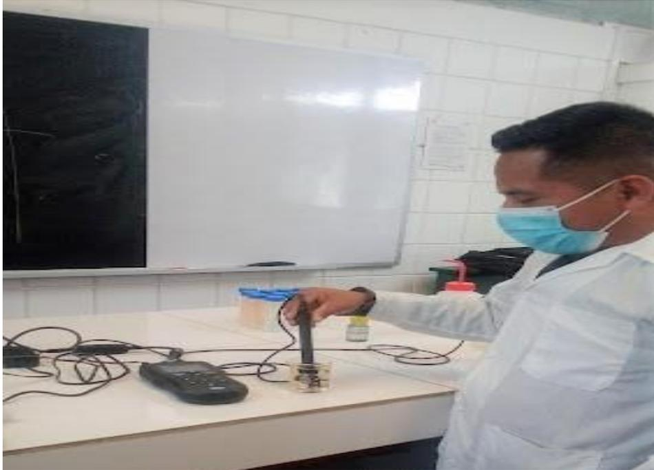
**Figura 53.** Medición de conductividad eléctrica
