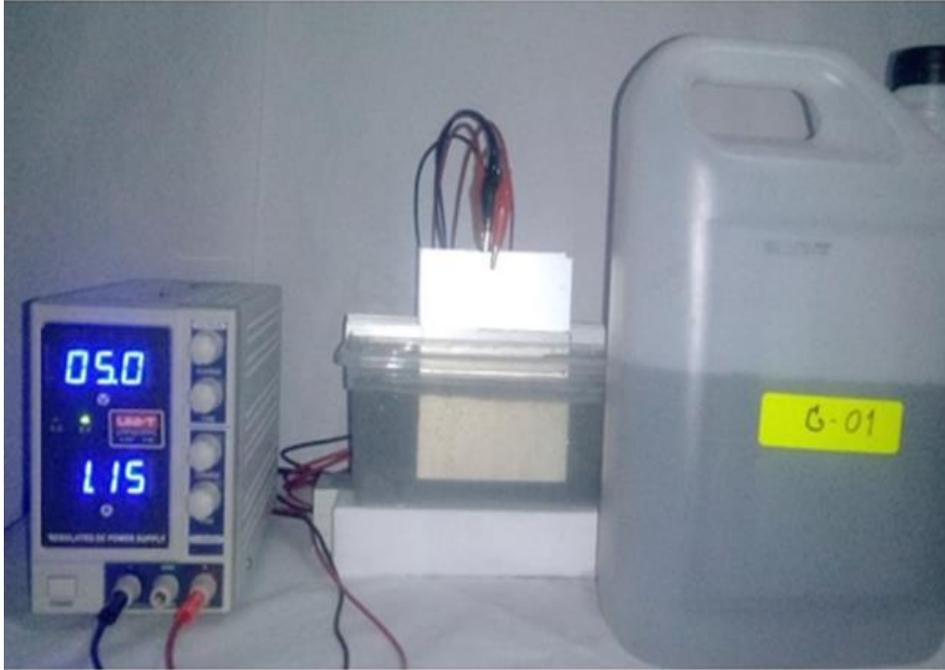
**Figura 43.** Operación de la celda electrocoagulación a 5 voltios
