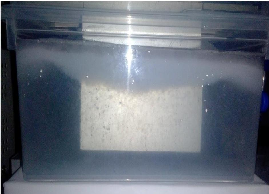
**Figura 46.** Electrocoagulación de la muestra pura del efluente
