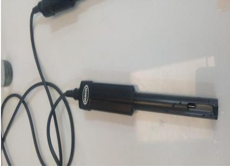
**Figura 59.** Electrodo marca HACH para medición de conductividad eléctrica
