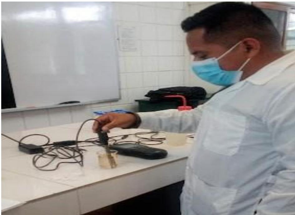
**Figura 54.** Medición de potencial redox
