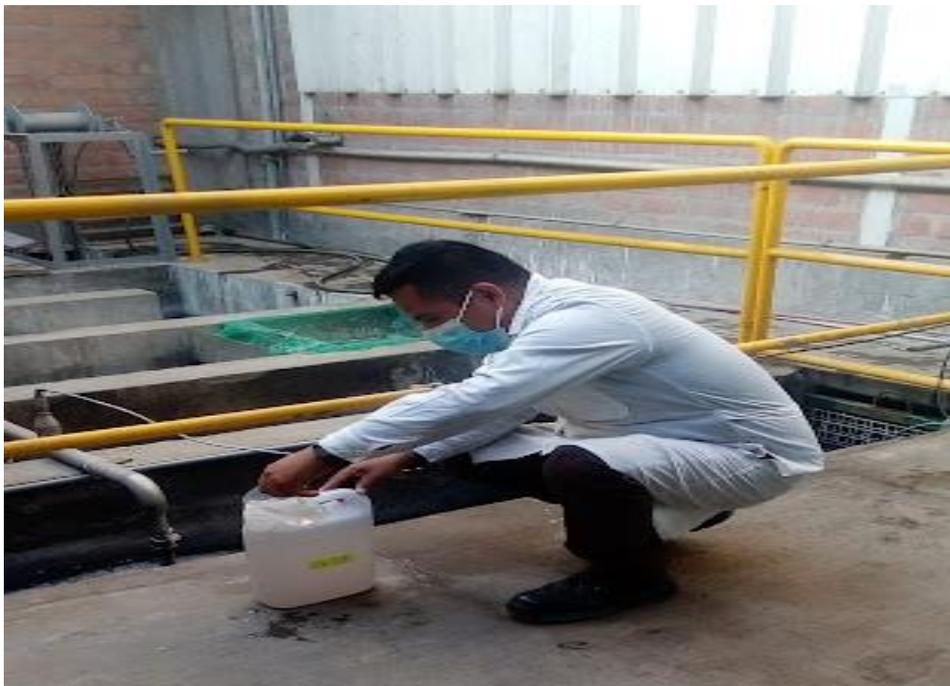
**Figura 36.** Muestreo del efluente con colorantes sintéticos
