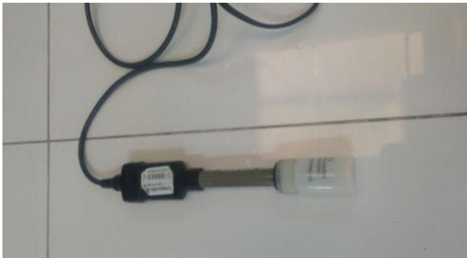
**Figura 60.** Electrodo marca HACH para medición de potencial redox
