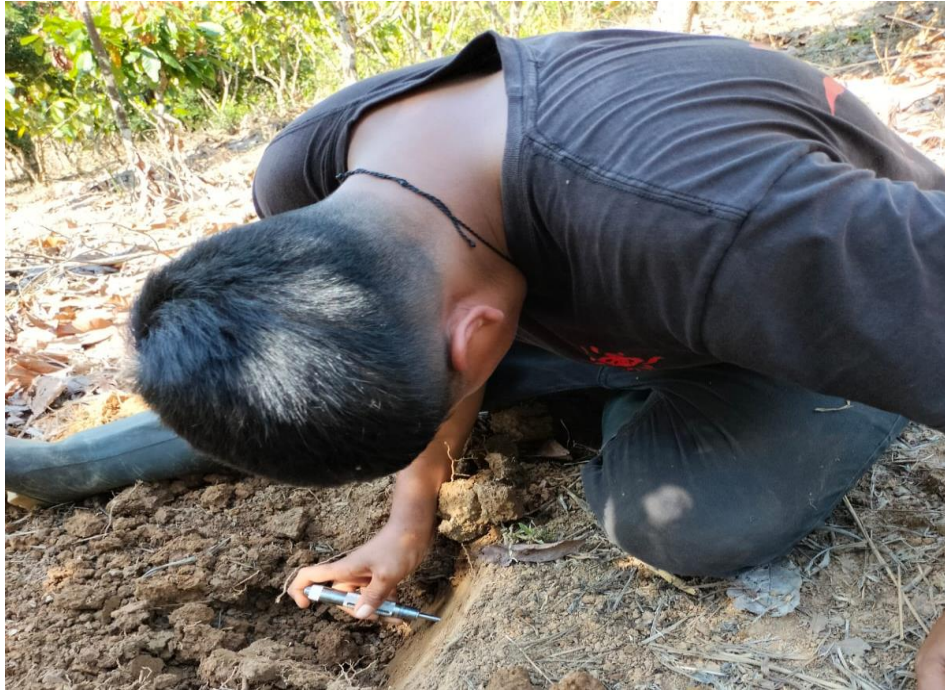
Figura 6. Lectura in situ de la resistencia a la penetración del suelo
