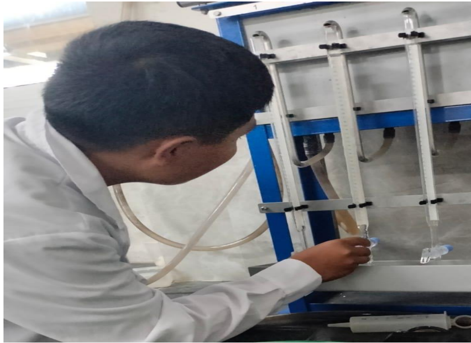
Figura 12. Análisis de conductividad hidráulica
