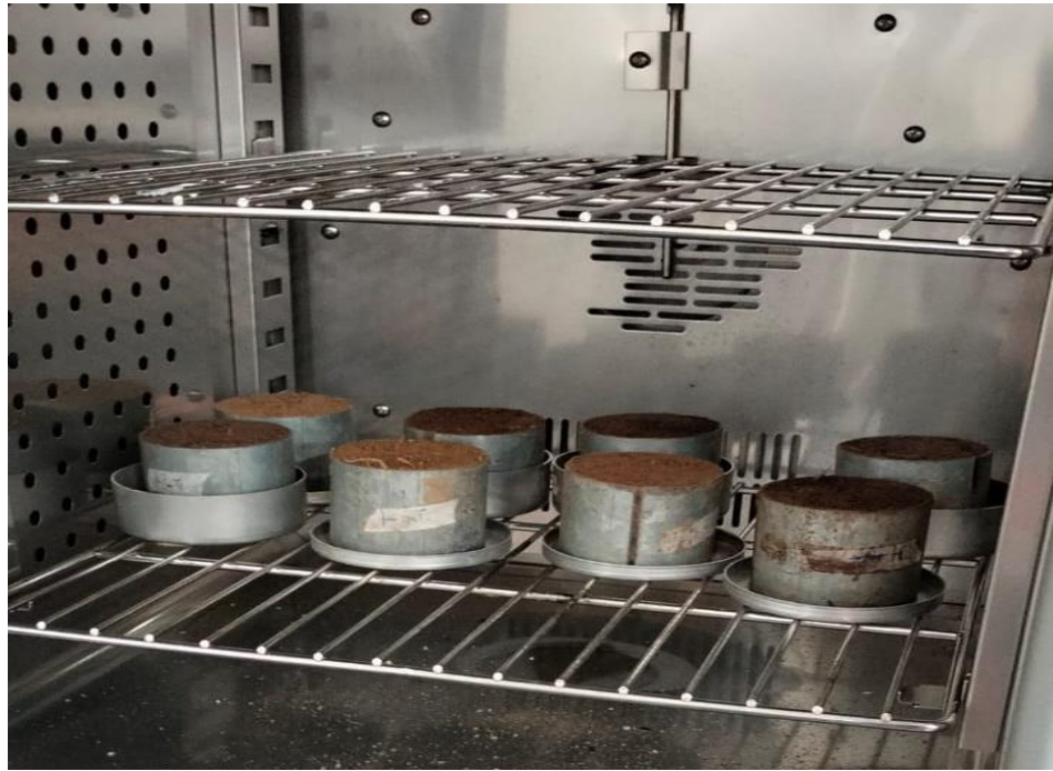
Figura 8. Muestras de densidad aparente en estufa
