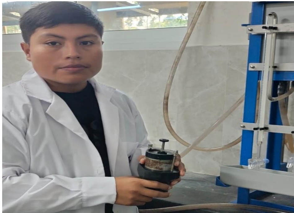
Figura 11. Preparación de muestra para el análisis de conductividad hidráulica
