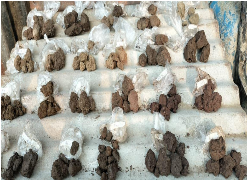
Figura 7. Secado de las muestras para densidad aparente (método de terrón parafinado)
