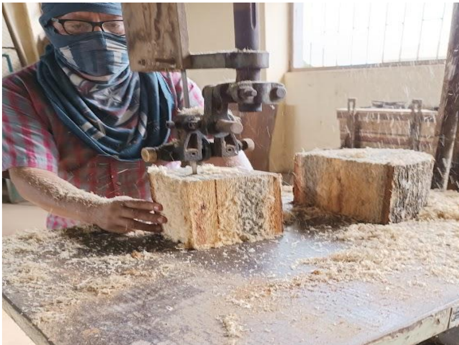
Figura 42. Habilitado de las dimensiones de las probetas para los ensayos físicos.
