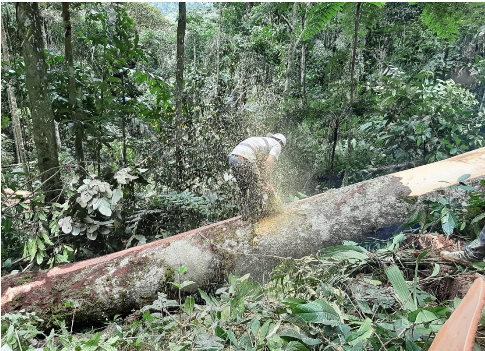
Figura 22. Trozado del fuste para no superar la capacidad de arrastre del tractor forestal.
