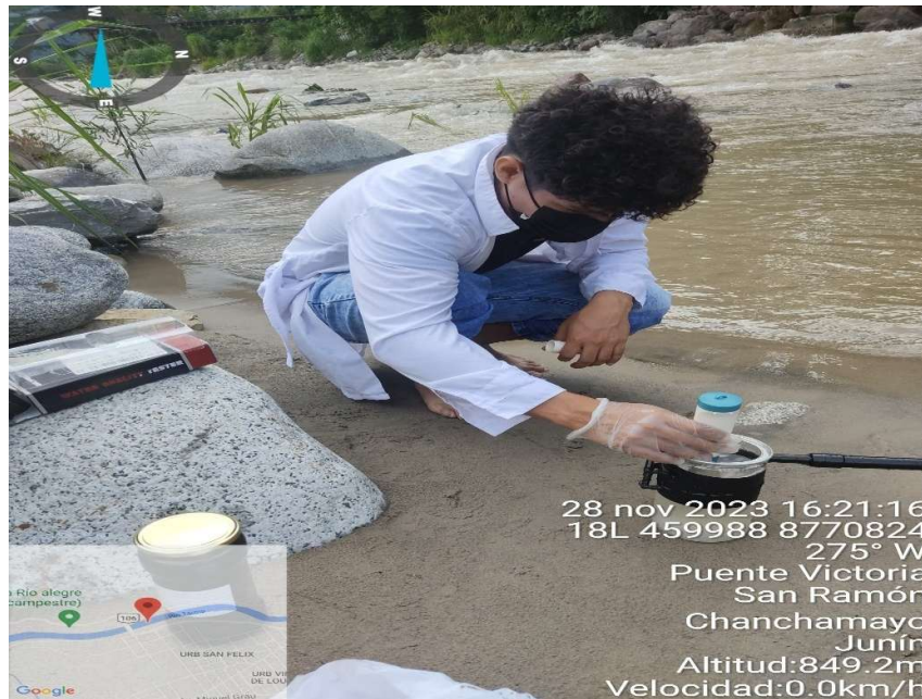
Figura 30. Medición de los parámetros de campo de muestras de agua del rio Tarma como parte del primer muestreo
