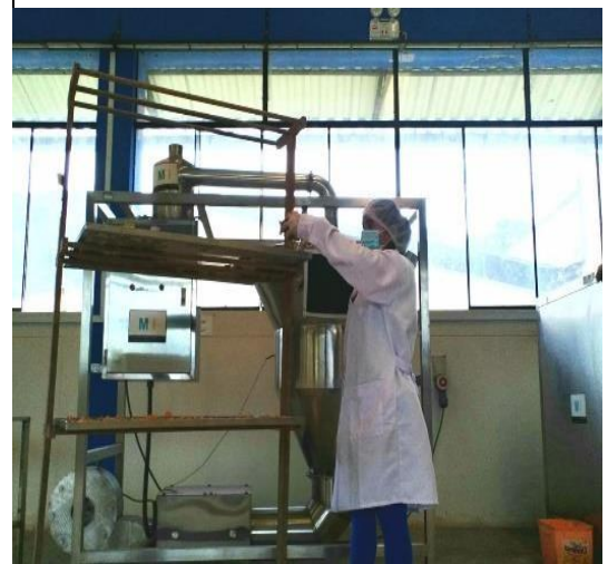
Deshidratado de la muestra e Sacha Jergón en el equipo de deshidratador de lecho fluidizado
