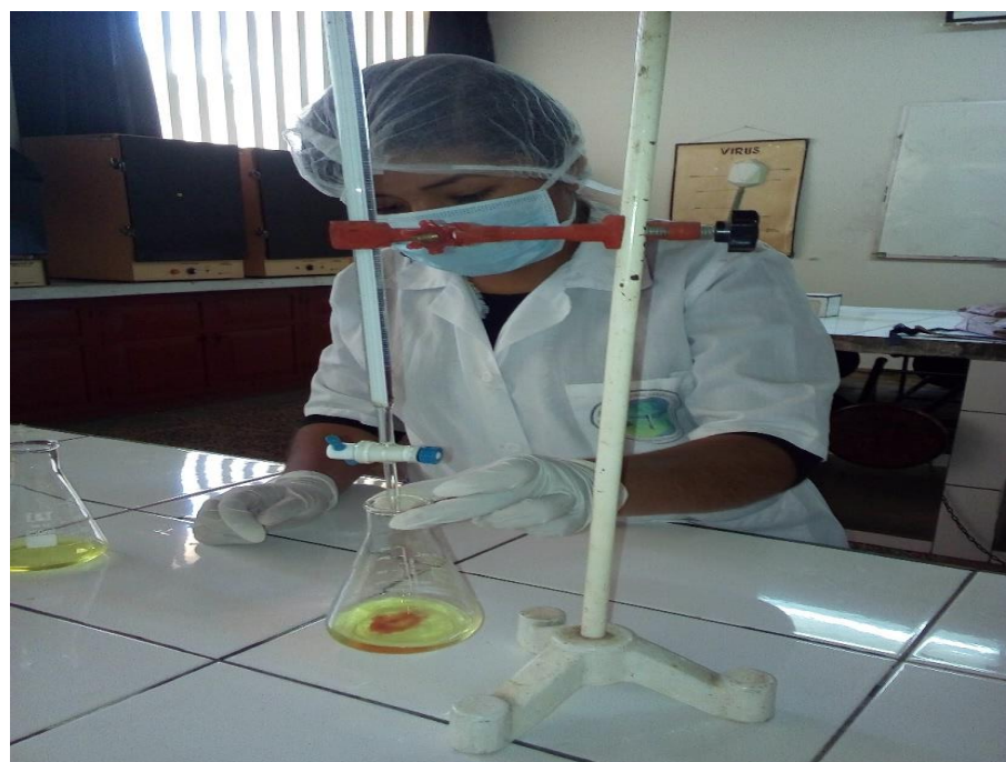
Figura 18. Determinación de cloruros por volumetría de precipitación
