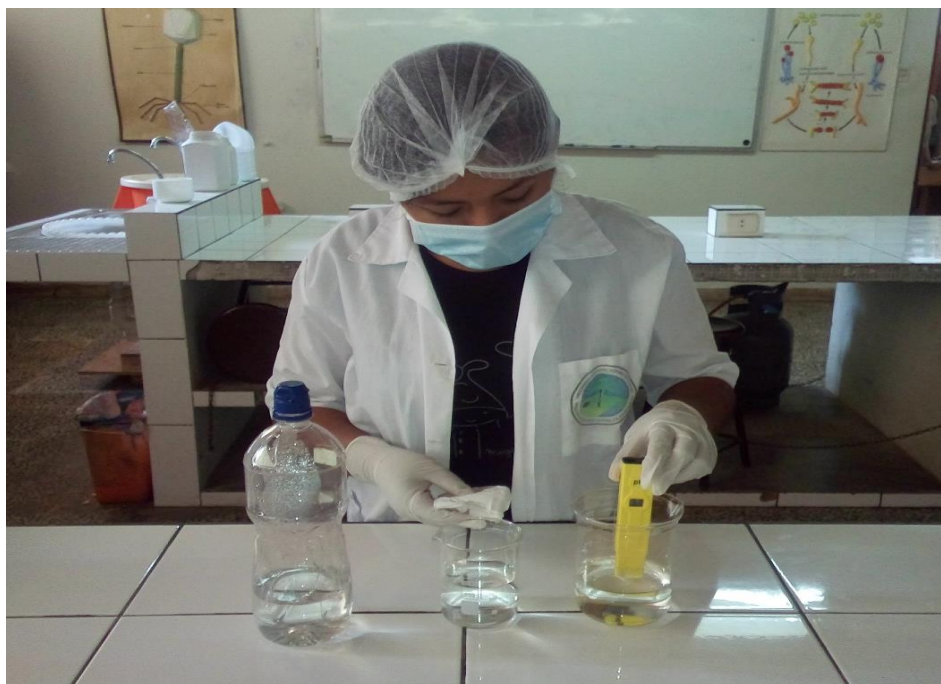
Figura 17. Medición del pH en la materia sedimentable soluble
