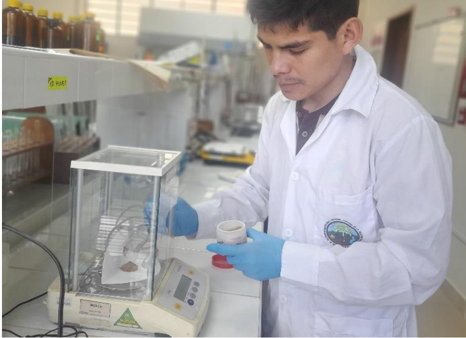
Figura 27. Pesado de la muestra de corteza para la extracción en el equipo Soxhlet.
