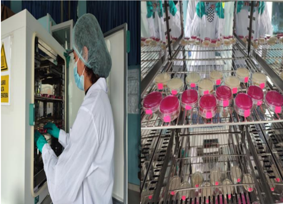
Figura 23. Incubación de bacterias coliformes totales y heterotróficas en la estufa
