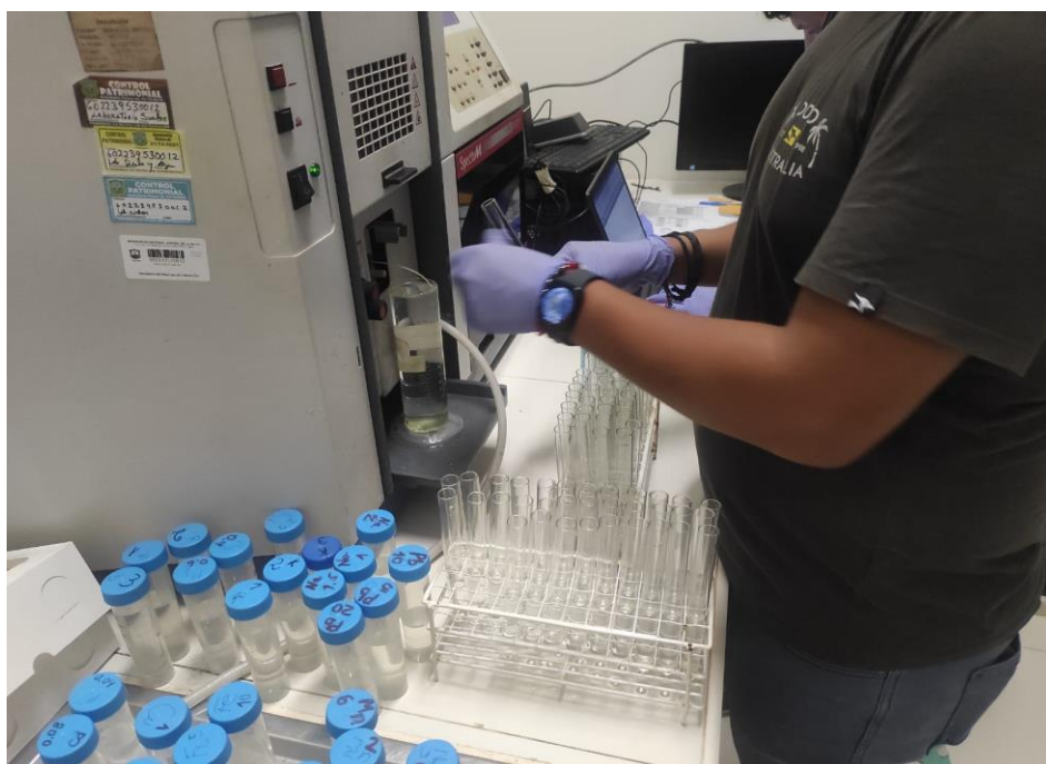
Figura 26. Identificación de las muestras con el instrumento espectrofotómetro de absorción atómica.
