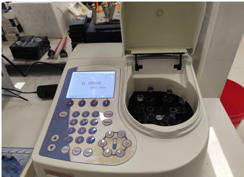
Figura 25. Determinación de fósforo por el instrumento espectrofotómetro UV.
