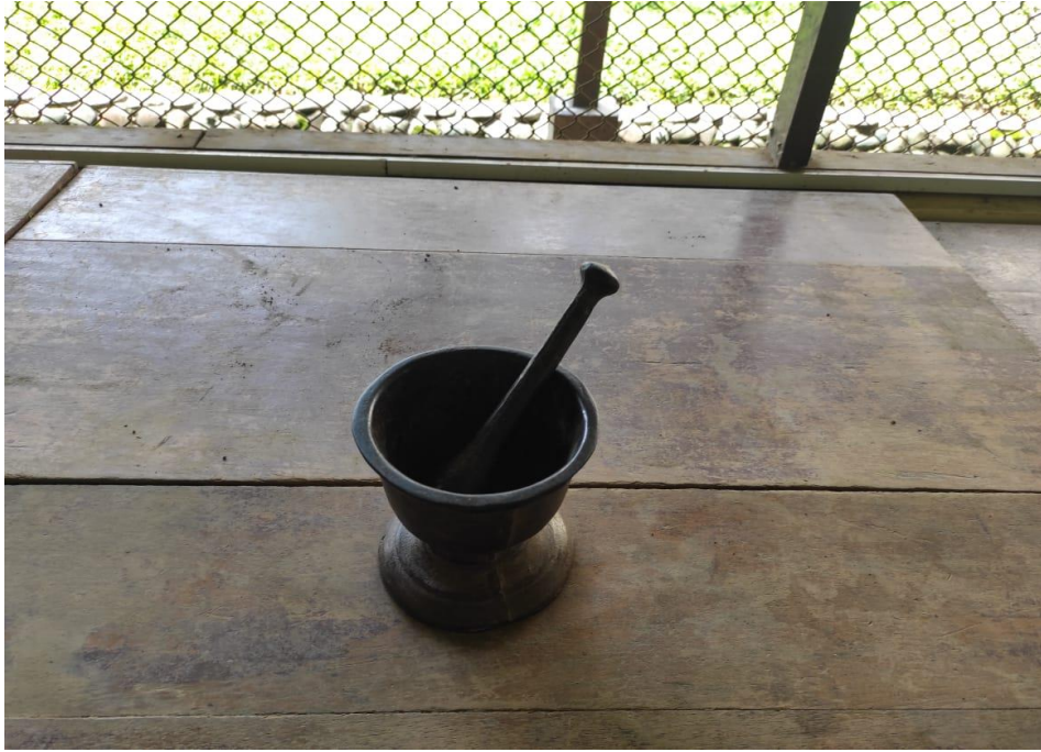
Figura 15. Mortero y pilón de hierro fundido para triturar las muestras del sistema de cacao.
