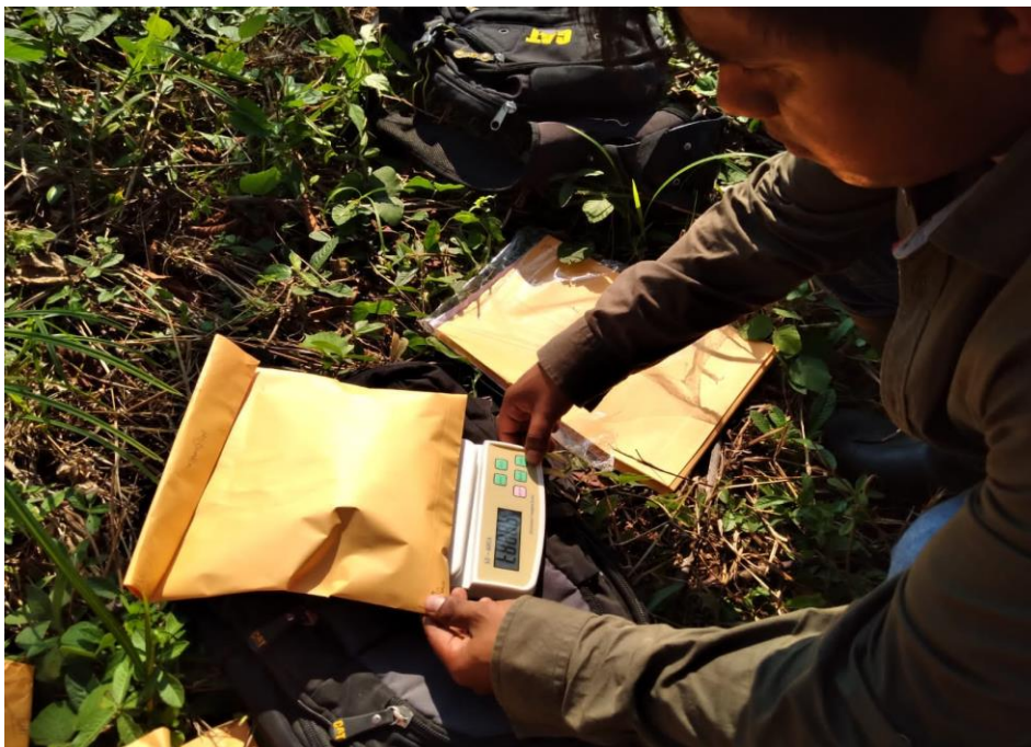
Figura 17. Pesaje de las muestras en estado húmedo
