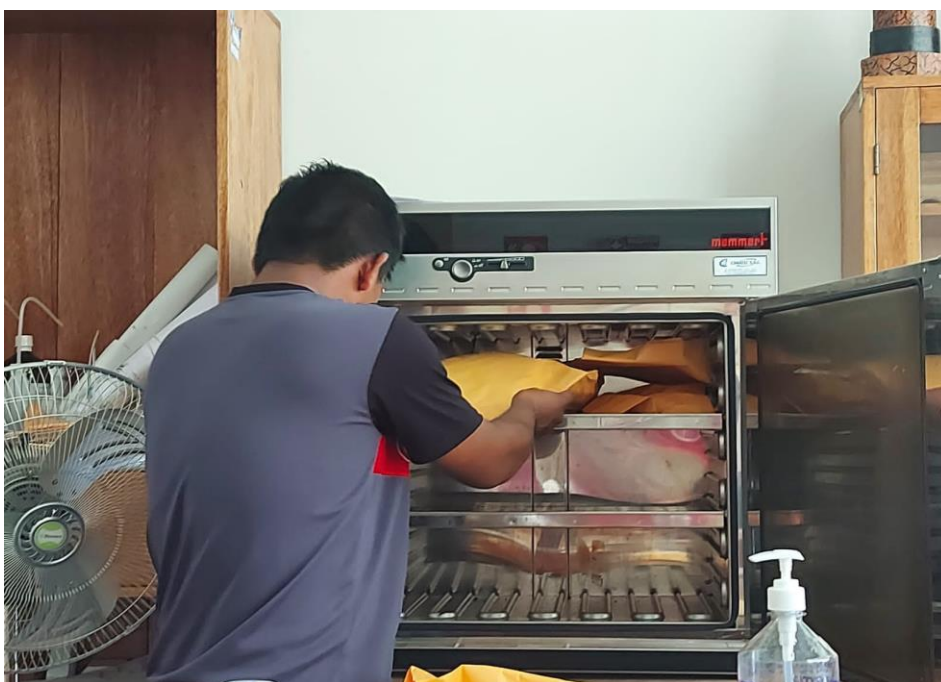
Figura 18. Secado de las muestras para obtener el peso seco
