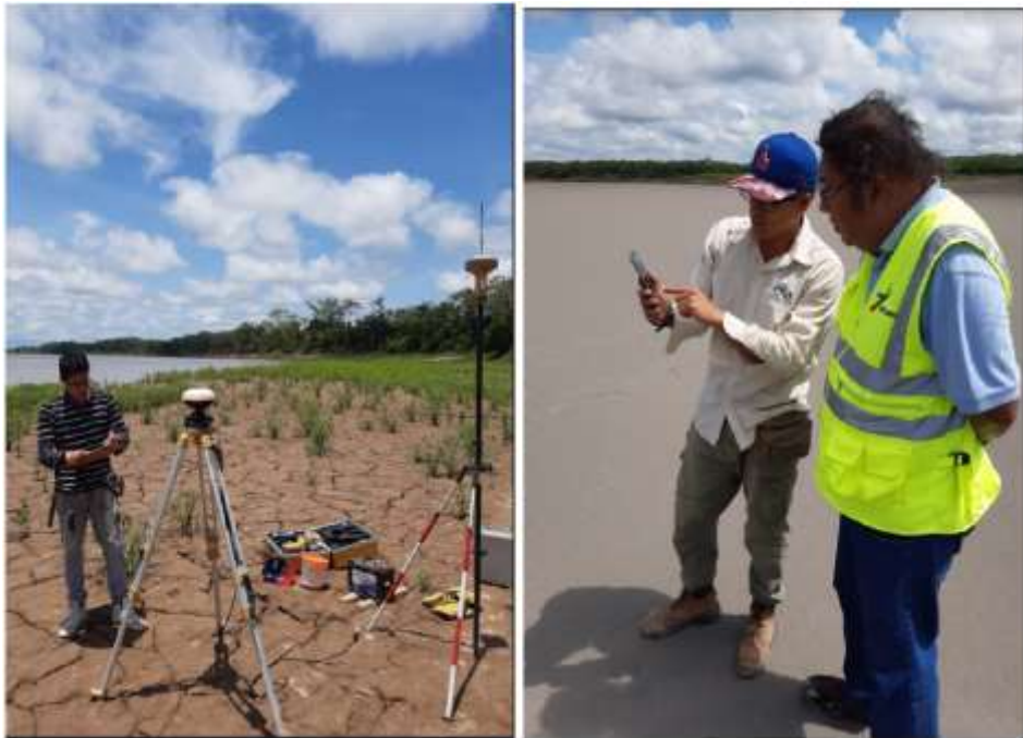
Figura 87. Colocación de puntos de control para el registro de niveles, caudales y batimetría del río
