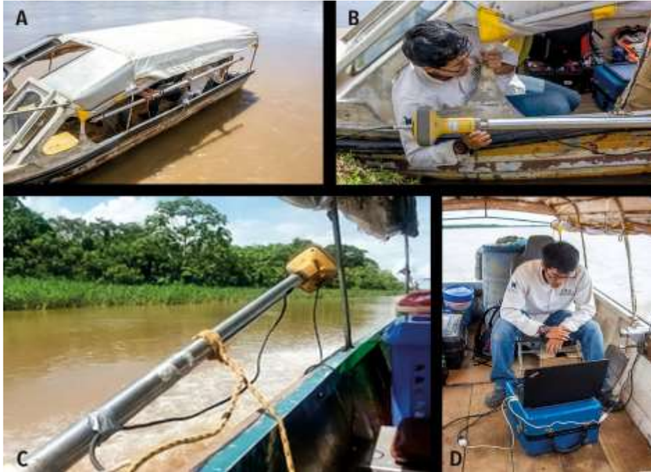
Figura 91. Mediciones en campo para la obtención de parámetros hidráulicos de los ríos Huallaga, Marañón y Ucayali
