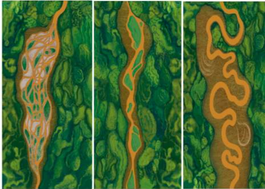
Figura 34. Tipos de ríos principales (A: Río trenzado “braided”. B: Río multicanal “anabranching”. C: Río meándrico)
