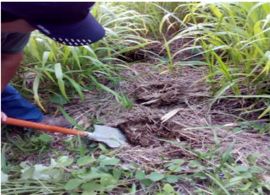
Figura 10. Extracción de muestras de suelo
