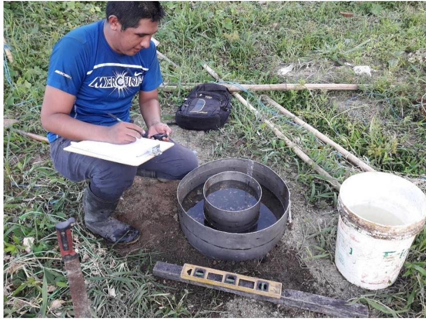
Figura 24. Realizando la evaluación de la capacidad de infiltración del tratamiento 3.
