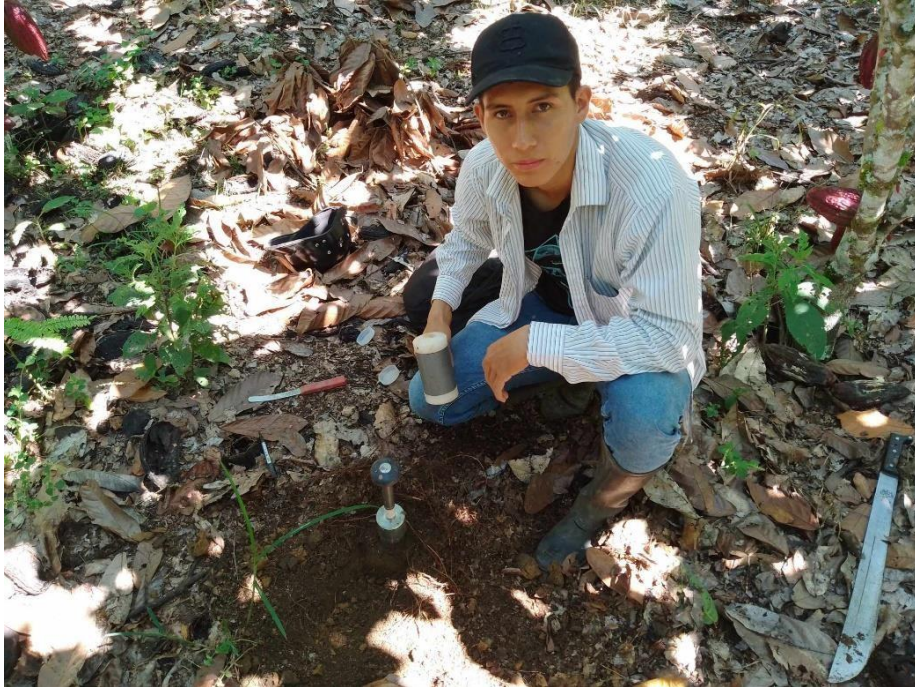
Figura 17. Recolección de muestras para conductividad hidráulica
