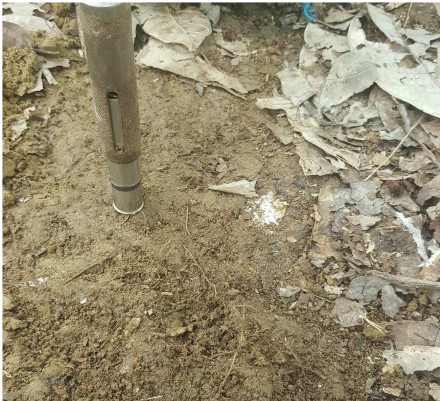
Figura 30. Medición de la resistencia mecánica a la penetración sistema de uso cacao fundo Liviac
