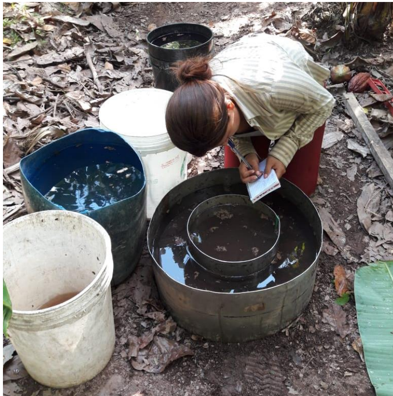
Figura 22. Evaluación de la velocidad de infiltración.
