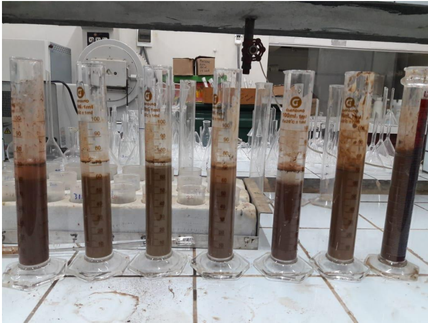
Figura 25. Evaluación de la densidad aparente – método de la probeta.
