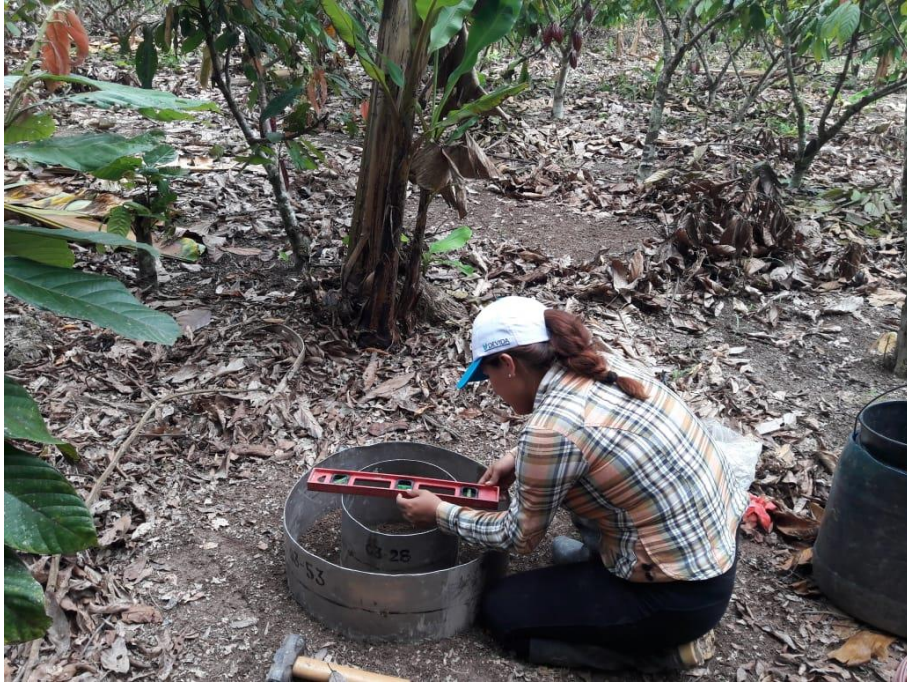
Figura 21. Instalación y nivelación de cilindros para evaluar la velocidad de infiltración.
