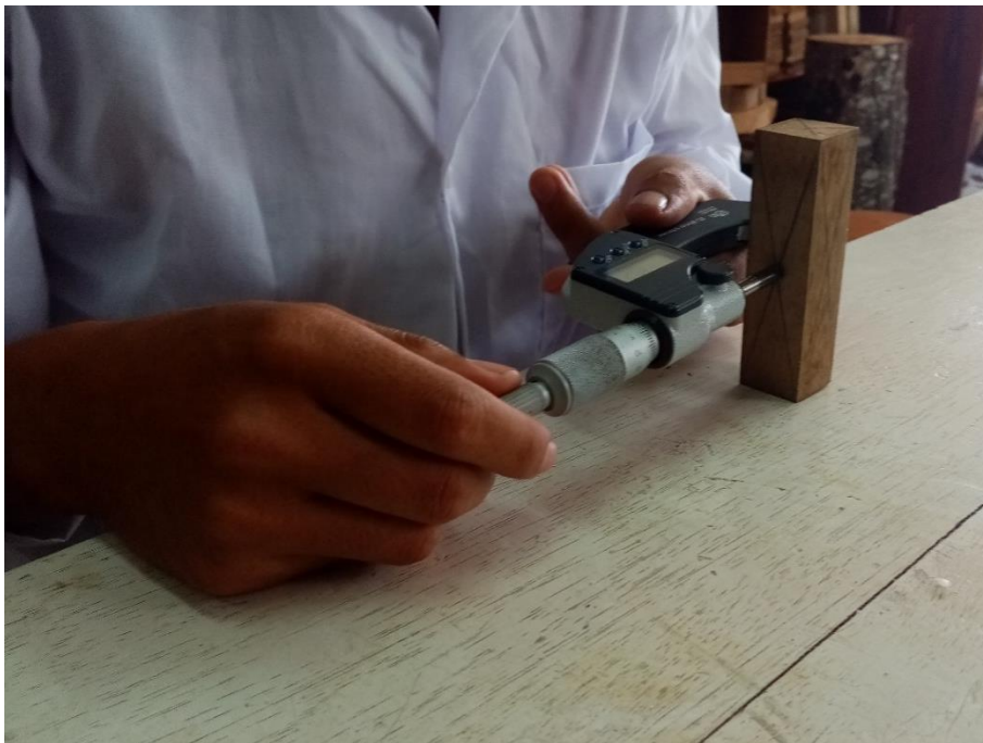
Imagen 14. Medición del lado radial y tangencial con el micrómetro digital
