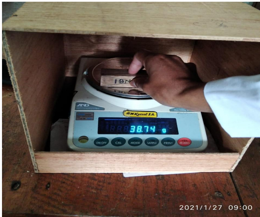
Imagen 16. Pesado de probetas en estado de saturado a estado anhidro
