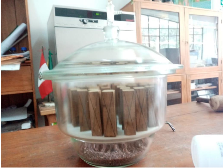
Imagen 17. Probetas en el desecador por 15 minutos
