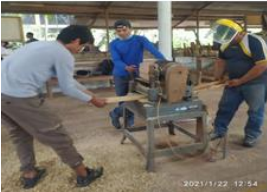
Imagen 11. Habilitado en la cepilladora calibradora
