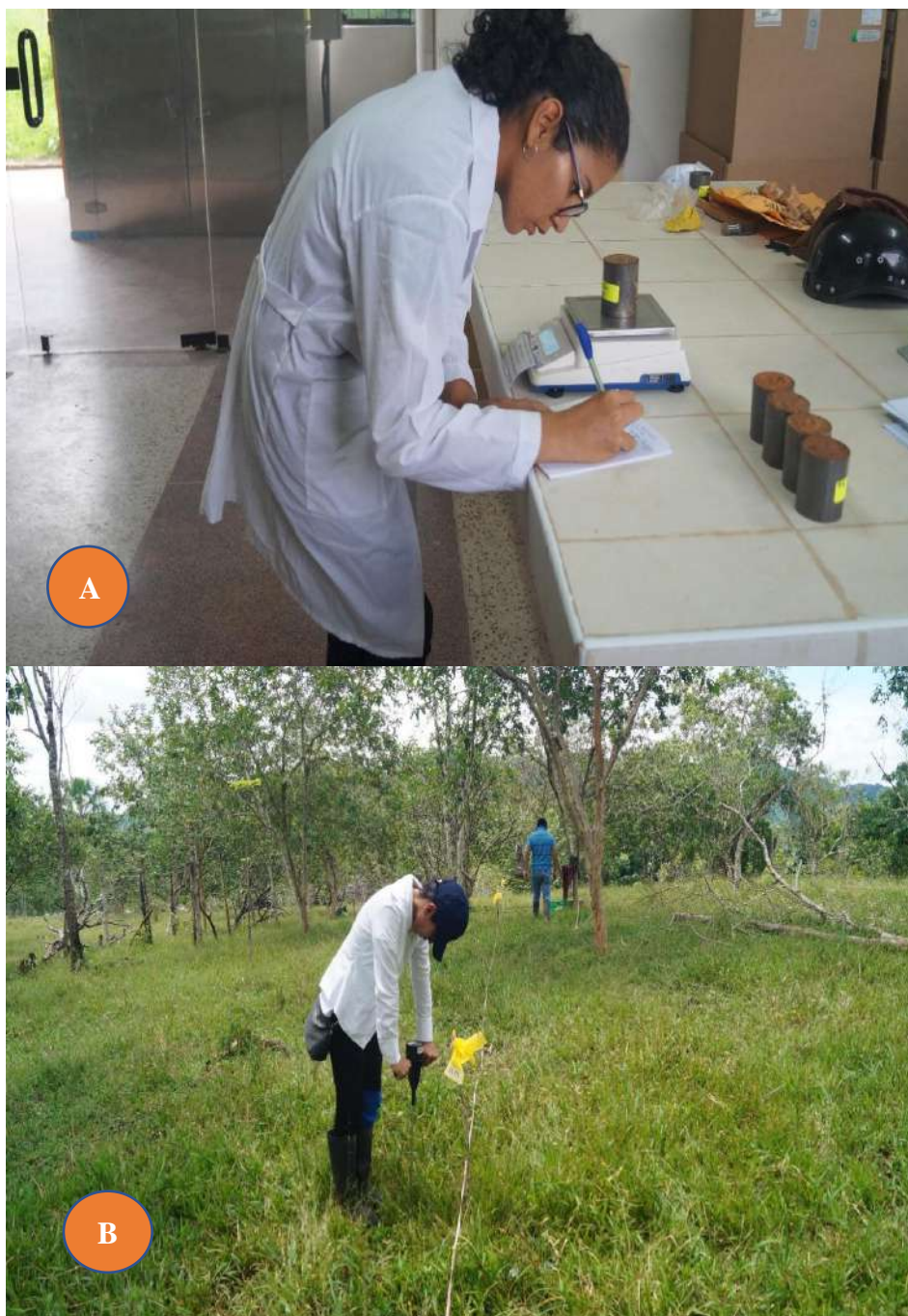
Figura 4. Evaluación para determinar la densidad aparente (A), y la evaluación de la compactación del suelo con ayuda del penetrómetro (B).
