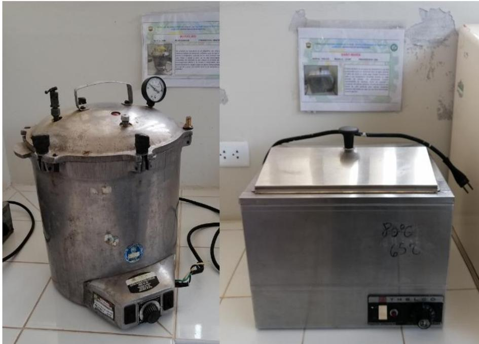
**Figura 11.** Autoclave y baño maría usados para los análisis.
