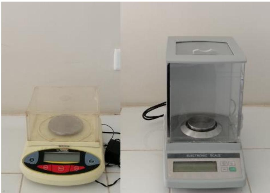
**Figura 8.** Balanza analítica y balanza analíticas digital, usadas para los análisis.
