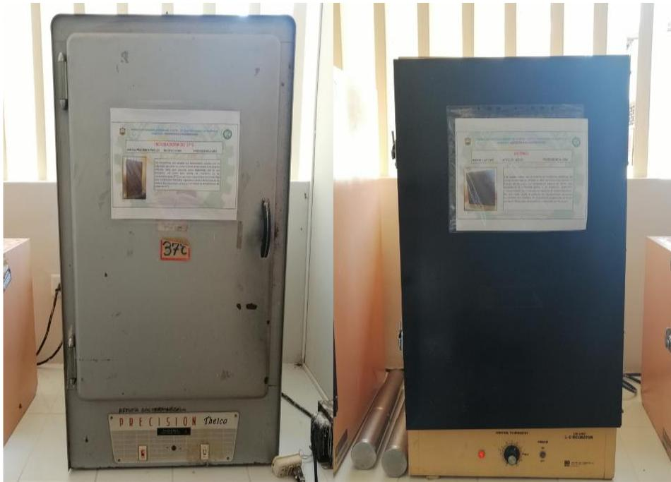
**Figura 9.** Incubadora de 37°C y horno usado para análisis.
