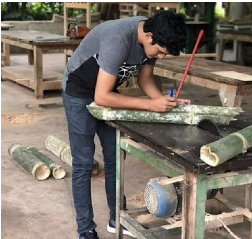
Figura 12. Codificación de secciones del culmo de bambú.
