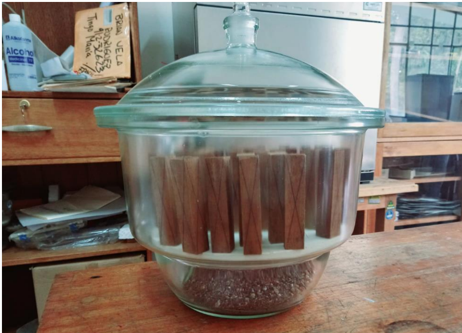
Figura 40. Probetas colocadas en el desecador después de ser retiradas de la estufa.
