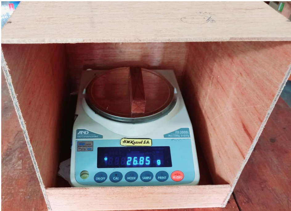
Figura 38. Registro de peso seco al aire de las probetas.
