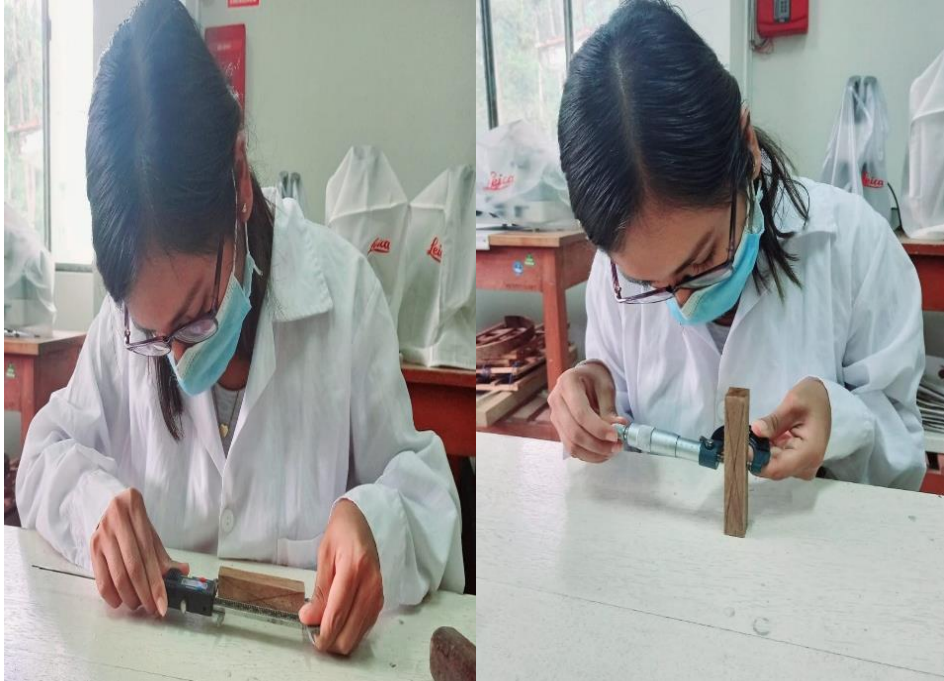
Figura 41. Medición y registro de las dimensiones de cada probeta.
