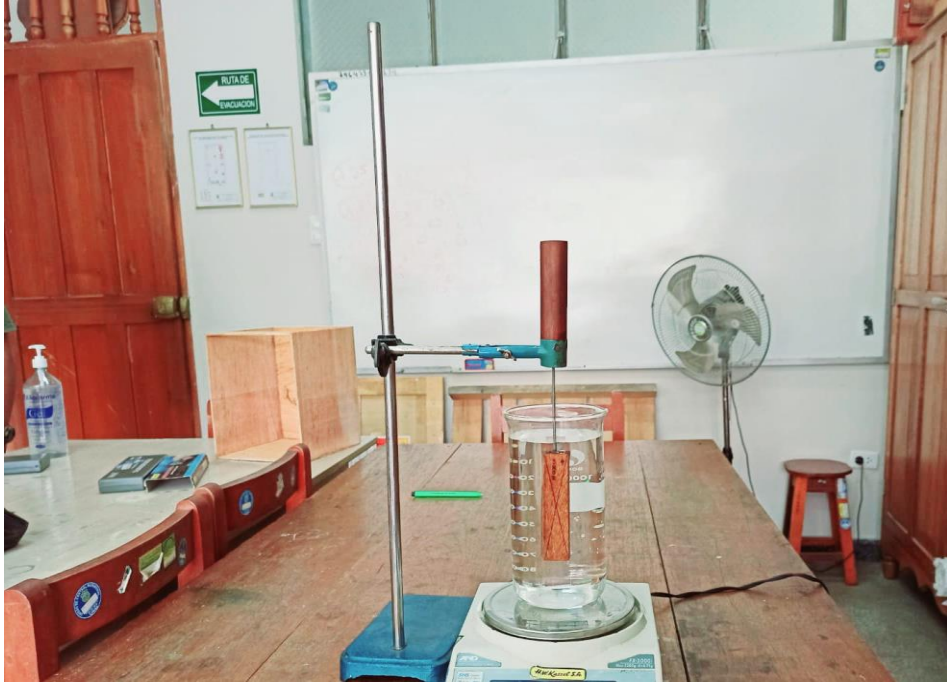
Figura 43. Determinación del volumen mediante el principio de Arquímedes.
