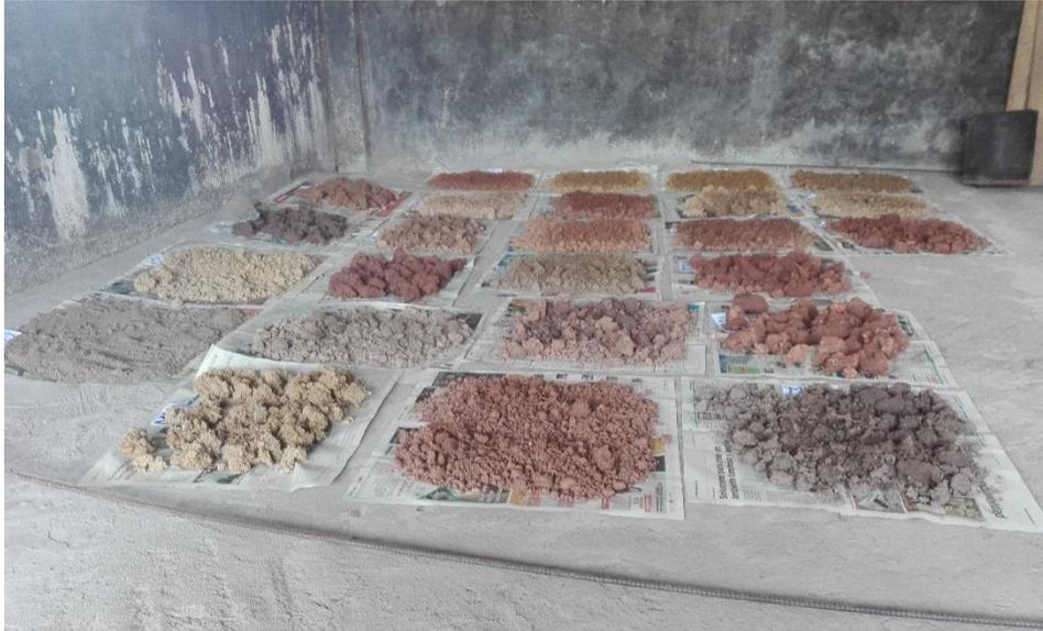
Figura 12. Proceso de secado de las muestras de suelo
