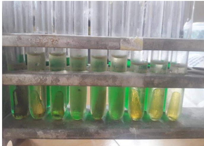
Figura 31. Visualización de los efectos en los análisis de coliformes totales.
