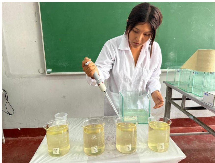
Figura 12. Adición de la dosis de la solución de hipoclorito de sodio.
