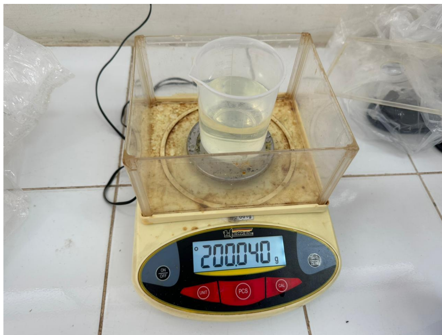
Figura 18. Medición del peso para la preparación de la solución desinfectante.
