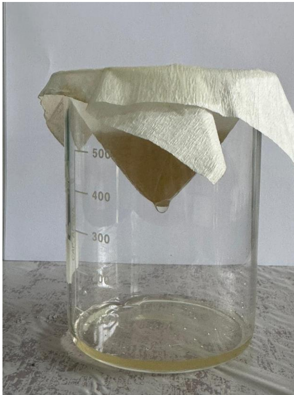
Figura 11. Filtración del agua residual doméstica utilizada en la investigación.
