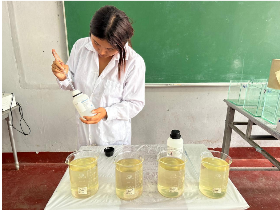
Figura 13. Adición de los contaminantes de plomo y cadmio al agua residual.
