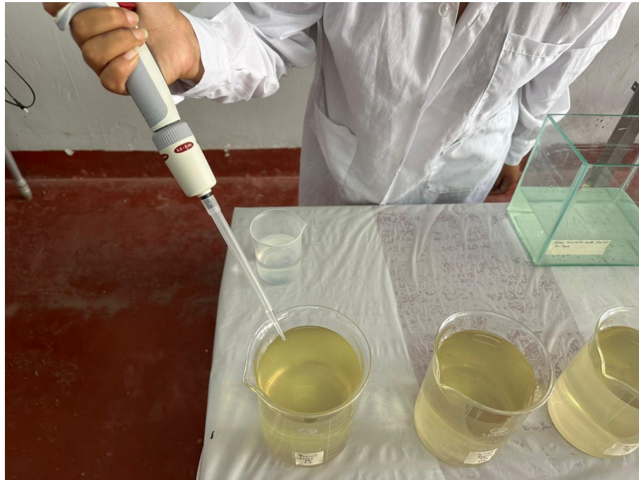
Figura 15. Cloración del agua contaminada con plomo y cadmio a diferentes concentraciones.
