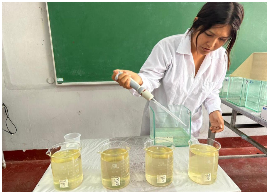
Figura 16. Cloración del agua contaminada con nitrato y fosfato a diferentes concentraciones.
