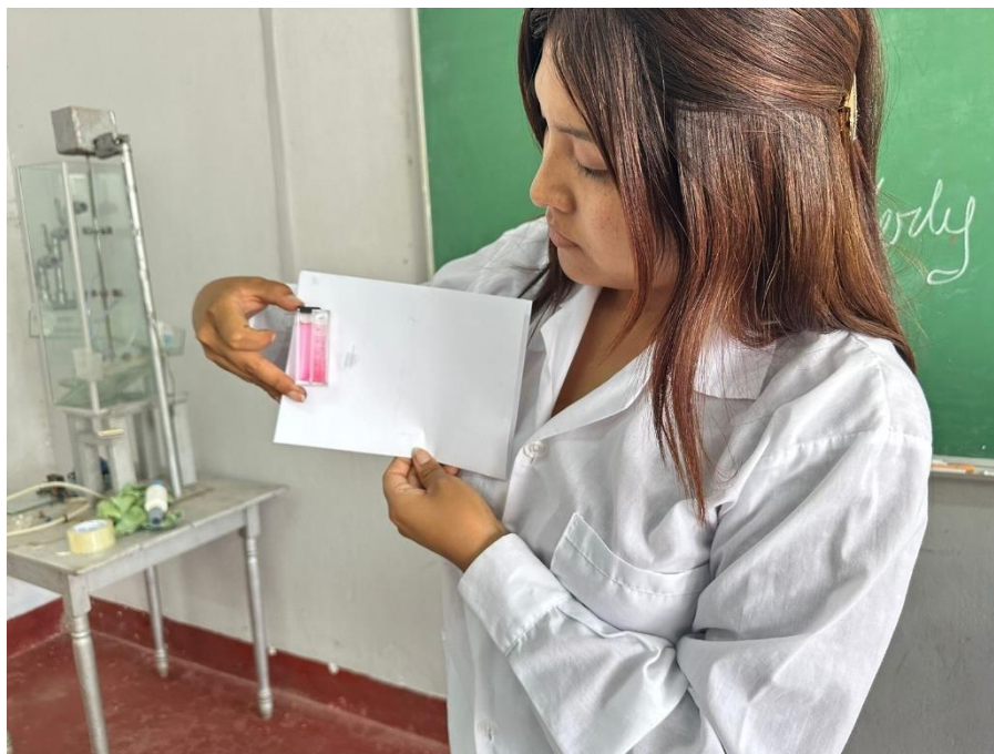
Figura 27. Medición del cloro libre residual en las unidades experimentales.
