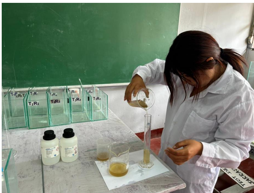
Figura 22. Preparación del agua residual con adición de plomo y cadmio de la investigación.
