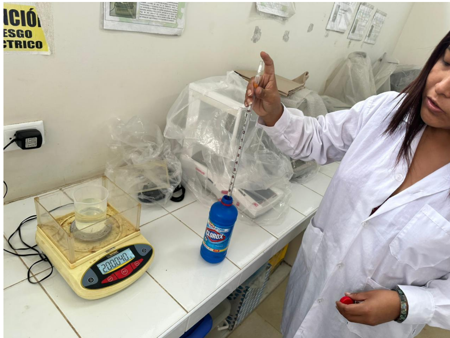
Figura 19. Adición del volumen exacto de hipoclorito de sodio
