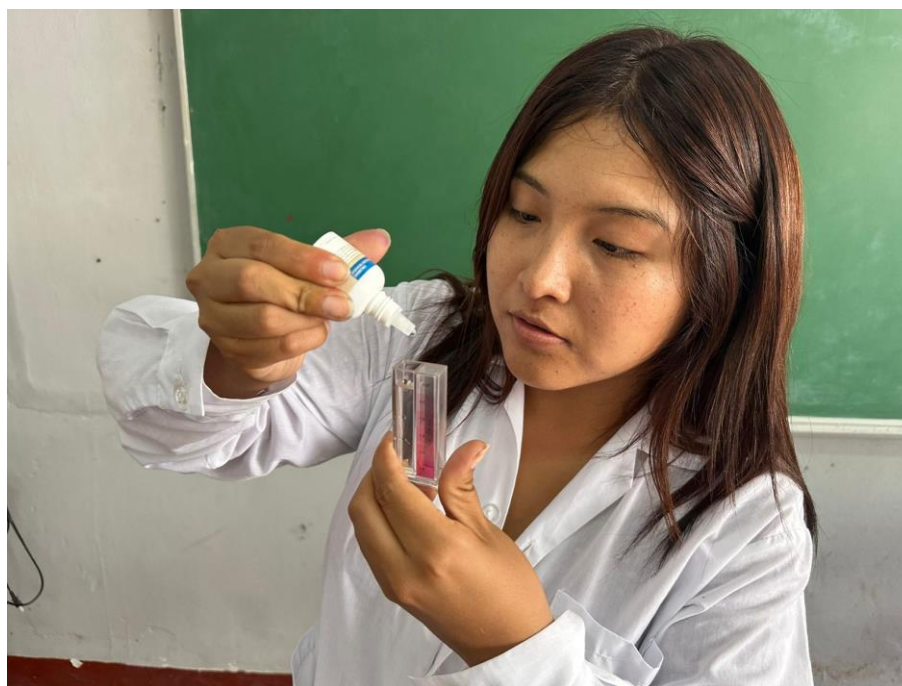
Figura 28. Adición de reactivos para la medición del cloro libre residual por colorimetría.
