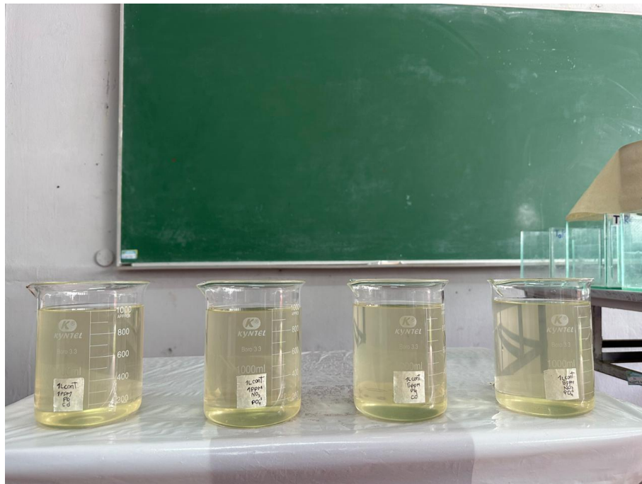
Figura 17. Aspecto del agua después los 30 minutos de la adición de cloro.
