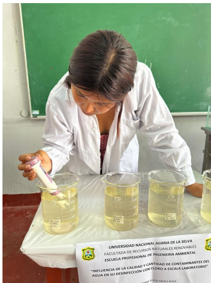
Figura 25. Toma de muestras después de la cloración para análisis de coliformes totales.
