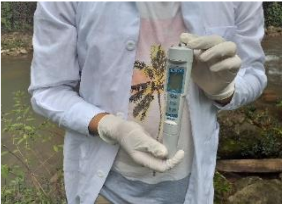
Figura 26. Toma de datos en campo con equipo medidor de conductividad eléctrica, temperatura y PH
